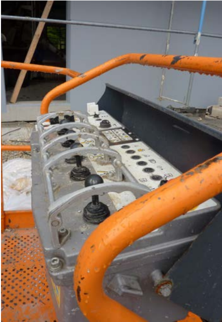
Bild 6-3 Schutzbügel gegen unbeabsichtigtes Betätigen der Bedienelemente
