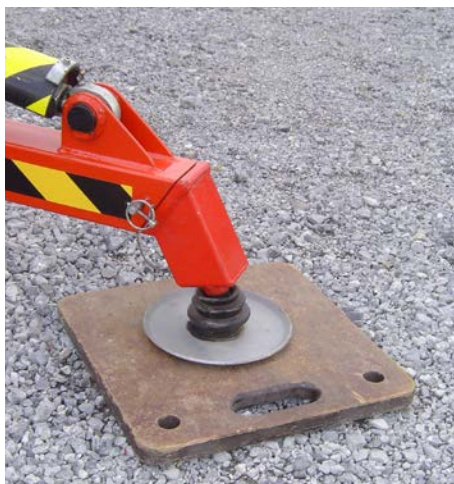
Bild 4-4 Positionierung der Stützfüße auf der Unterlegplatte
