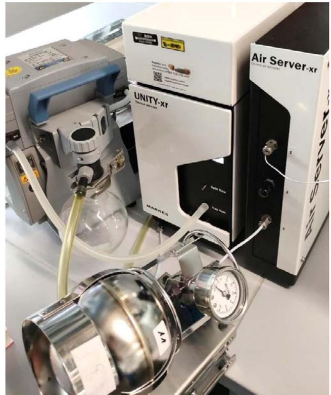
Probenahmekanister mit Anschluss an Air Server für die Offline-Analyse
