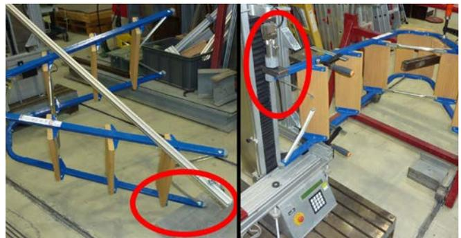
Prüfaufbau für Tritthocker nach ANSI ASC A14.11-2018 (links) und nach DIN EN 131 2: 2017 (rechts)
