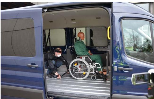
Sichern eines Rollstuhls im Fahrzeug
