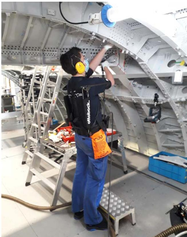
Nutzung eines schulterunterstützenden Exoskelettes bei Über-Schulter-Montagetätigkeiten im Flugzeugbau.
