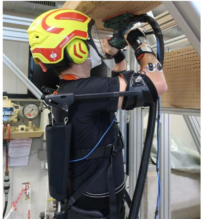
Hand-Arm-Vibration: Messung der Vibrationsbelastung bei Arbeiten mit Exoskeletten
