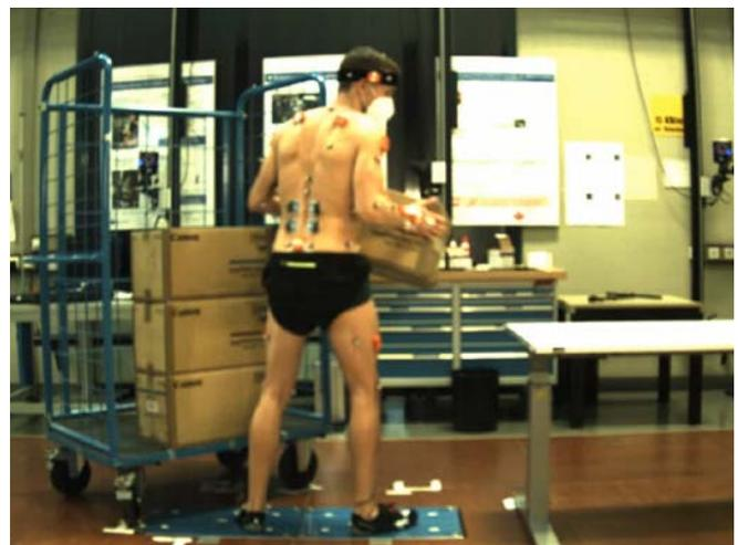
IMU und optische Bewegungserfassung im Vergleich während manueller Tätigkeiten der Lastenhandhabung
