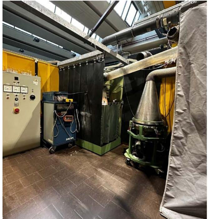
Der alte Prüfstand für Schweißrauchabscheider im IFA soll nun umfassend modernisiert werden
