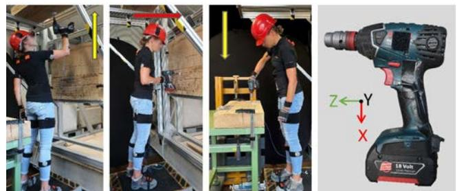
Körperhaltung und Hand-Arm-Vibration: Einfluss von verschiedenen Körperhaltungszuständen auf die Vibrationsexposition
