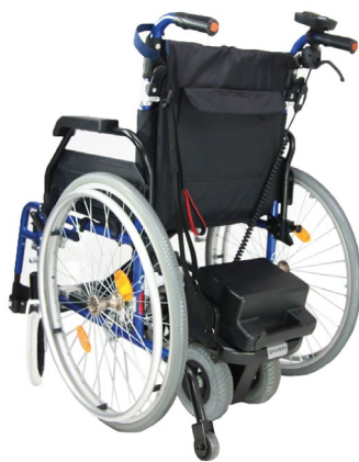
Abb 10 Rollstuhl mit Brems- und Schiebehilfe
