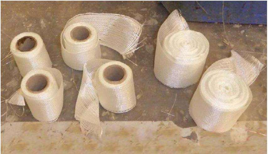
Abb. 33 glasfaserverstärktes Gewebeband
