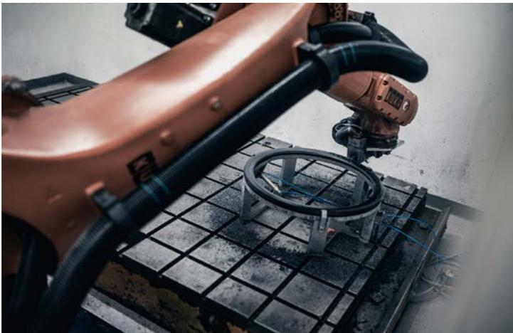
**Abb. 41**     robotergestützte Schleif- und Fräsarbeiten
