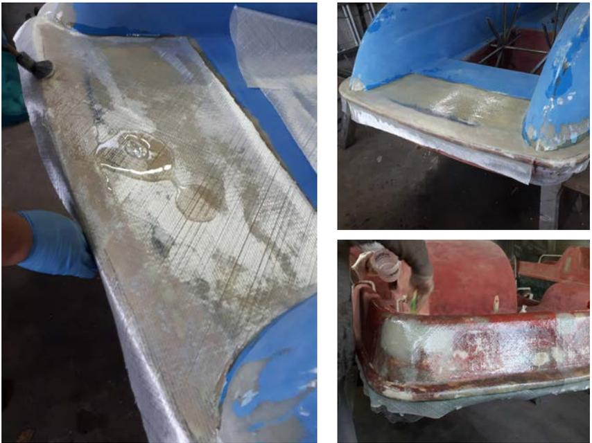
Abb. 28 a–c Laminieren im Bootsbau
