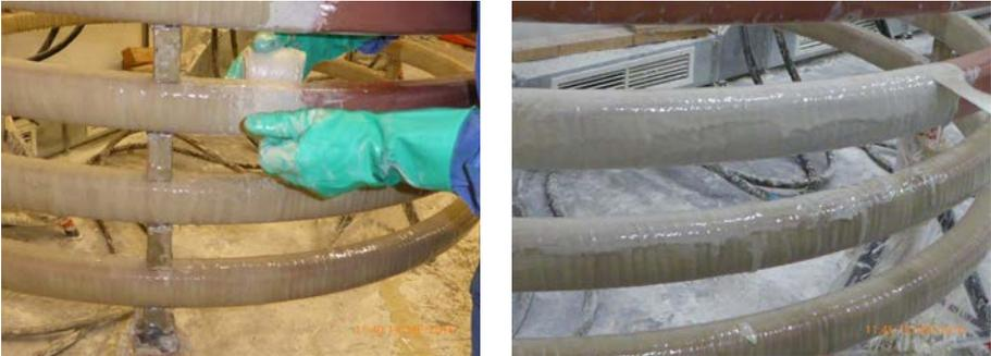
Abb. 34 a, b Umwickeln der Spulen mit epoxidharzgetränktem Gewebband
