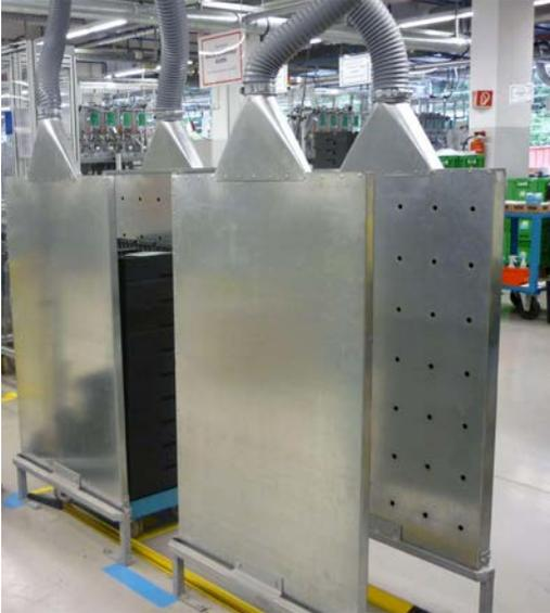
Abb. 21 Abgesaugter Hordenwagen
