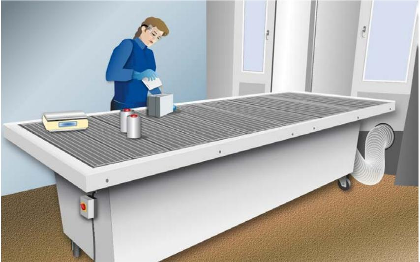
Abb. 17 Abgesaugter Arbeitstisch
