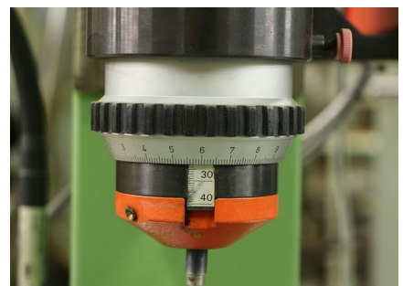
Abb. 13 Presskopf einer Nietmaschine
