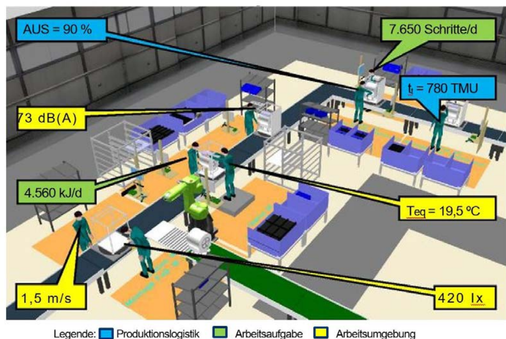
Abbildung 3: Vision der Prognose von Arbeitsbelastungen in der Digitalen Fabrik. Quelle: [12]
