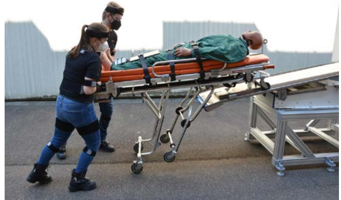
Abbildung 1: Mit der CUELA-Messtechnik wurden beim Einladen manueller (oben), semi-automatischer (Mitte) und vollautomatischer (unten) Fahrtragen die Körperhaltungen und Kräfte ermittelt. Quelle: IFA
