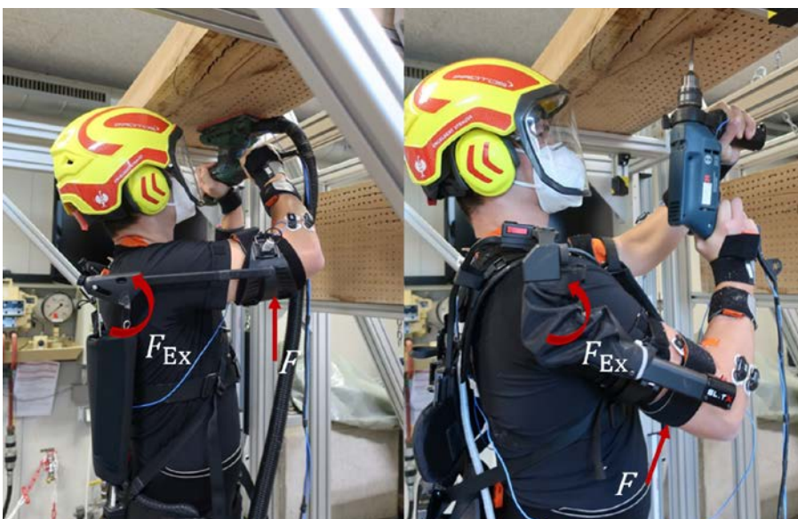
Abbildung 1: Passive Exoskelette für die oberen Extremitäten mit Vibrationseinwirkung und Unterstützungsmoment ( F_{EX} ). Quelle: Autor
