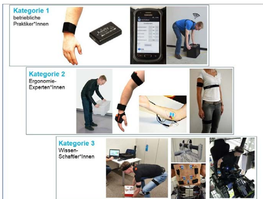
Abbildung 1: Kategorien 1 bis 3 von Messsystemen zur messwertbasierten Gefährdungsbeurteilung physischer Belastungen Quelle: Autoren
