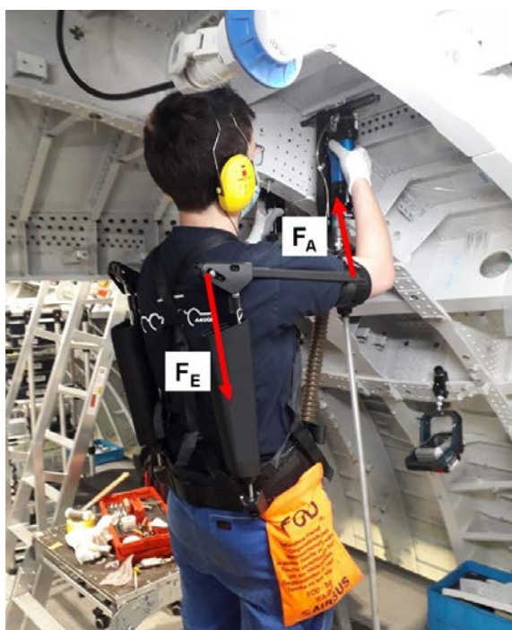
Abbildung 3: Beispiel für das Funktionsprinzip eines Exoskelettes für die oberen Extremitäten. Das Exoskelett erzeugt über ein Federsystem eine nach unten gerichtete Federkraft FE, die wiederum mittels eines Hebelarmes am Exoskelett ein entsprechendes Rückstellmoment erzeugt. Dieses überträgt wiederum über den zweiten Hebelarm eine entsprechende Kraft FA auf den Oberarm, was eine Verringerung des Schulterelevationsmomentes bewirkt. Dadurch soll die Beanspruchung der Schultermuskulatur reduziert werden. Quelle (modifiziert): © Airbus Defence & Space GmbH, 2021)
