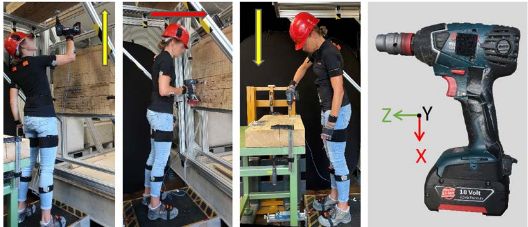
Abbildung 1: Testperson mit Tätigkeiten in drei Arbeitsrichtungen (links); Schlagschrauber mit einem adjustierten Beschleunigungssensor (rechts). Quelle: Autoren
