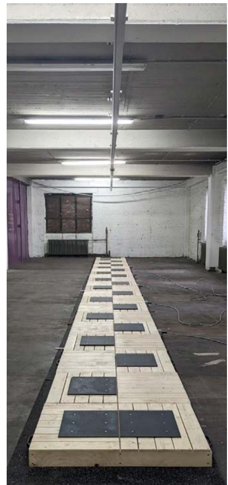
Abbildung 2: Aufbau eines Stolper-, Rutsch- und Sturzparcours einschließlich eines Überkopf-Sicherheitssystems (Decke) auf dem Gelände eines Kooperationspartners. Quelle: Autoren
