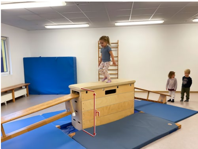
Abb. 2 Fallhöhe (h) = Abstand zwischen Standfläche auf Kasten und Fallbereich
