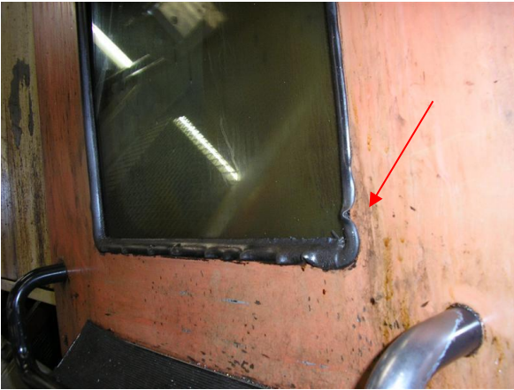
Abbildung A5 – Durch Kühlschmierstoff gequollene Scheibenabdichtung. Die seitliche Dichtigkeit zu den Polycarbonat-Scheibenkanten ist nicht mehr gegeben (gilt auch für rissige Scheibenabdichtungen)
