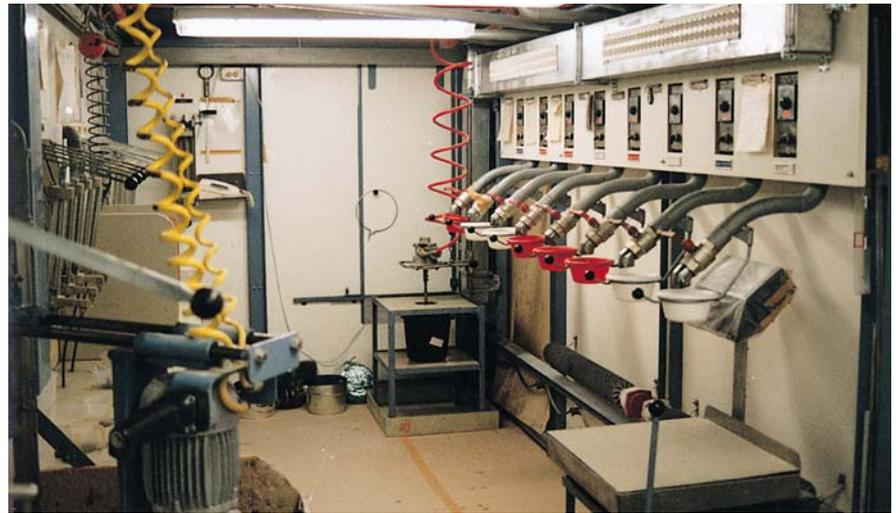
Das Anmischen des Harzes mit Härter und Beschleuniger sollte über Dosierstationen erfolgen. Beim Anmischen von Hand mit Dosierbechern bestehen Gesundheitsgefahren durch
