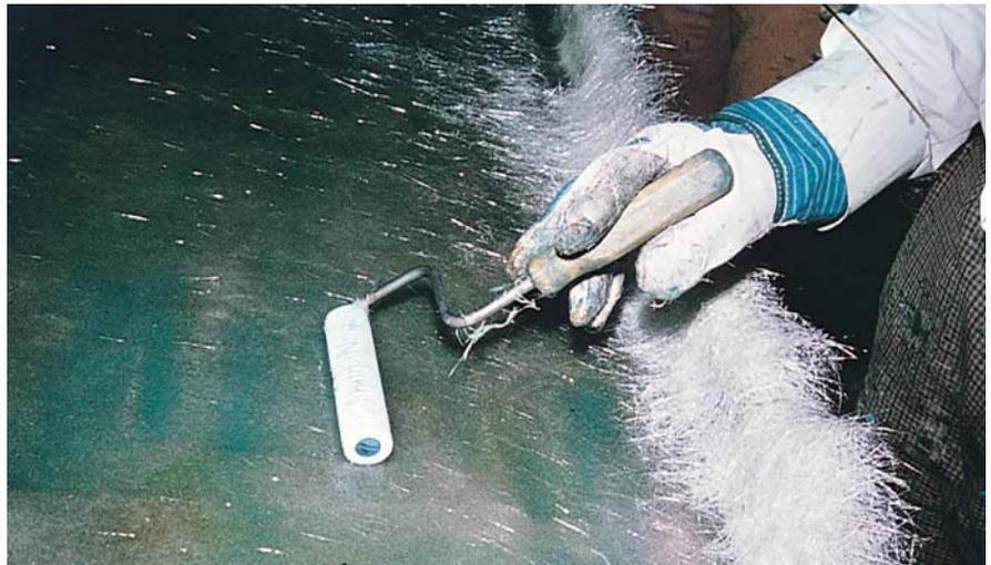
Beim **Faserspritzen** werden Fasern in einer Spritzpistole gehäckselt, mit Harz vermisch und in dieser Zusammensetzung auf eine Form aufgespritzt.
