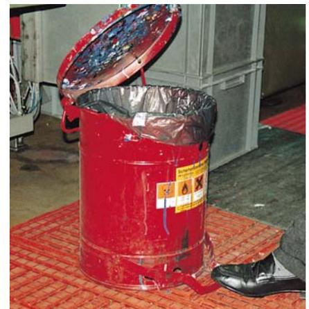
Abfallbehälter für Harzreste und andere Abfälle müssen aus unbrennbarem Material (z. B. Stahl, Aluminium) sein und einen selbstschließenden Deckel haben.
