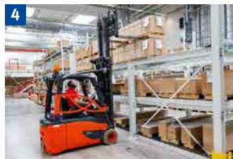
4 Mit hochgestellter Last nur zum Auf- und Absetzen verfahren. Hubgerüst nur über Stapelfläche nach vorne neigen.
