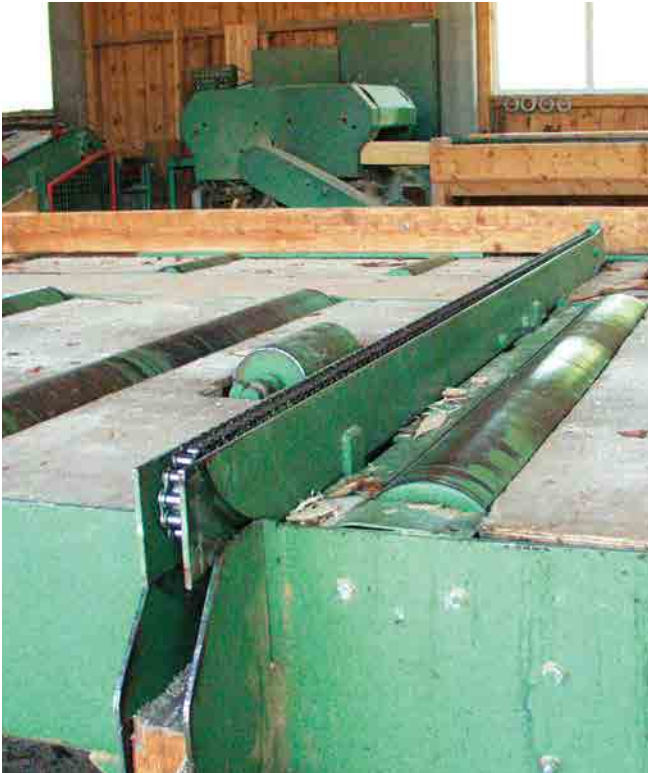
Abb. 31 Querförderer als Winkelübergabe im Abzugsrollengang (obere Endstellung)
