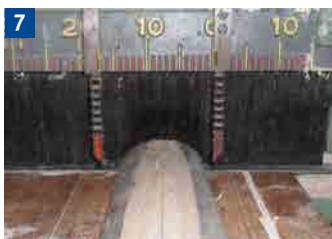
Eine leichtgängige Rückschlagsicherung umschließt das Werkstück lückenlos und verhindert das Herausschleudern von Splintern.
