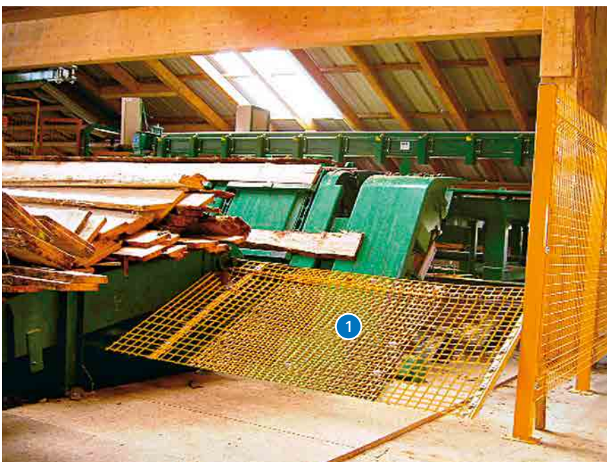
Abb. 30 Ausführungsbeispiel einer abweisen- den Schutzvorrichtung als Teil der Zugangssicherung zum Gefahrenbereich einer Vereinzelung
