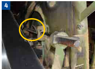
Formschlüssige Sicherung gegen Herabsinken des Sägerahmens
