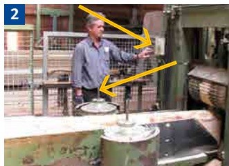
Störungsbehebung am Spaltkeil, Auszugswalzen mit Griff
