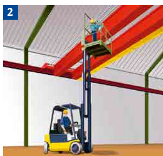
Instandhaltungsarbeiten mit Gabelstapler und Arbeitsbühne
