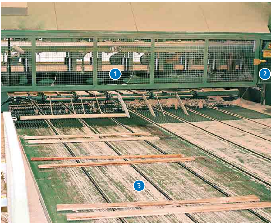
Abb. 34 Ausführungsbeispiel Stetigförderer für Seitenwarenabtransport, um den Zugang zum Gefahrenbereich der Mehrblattkreissäge zu verhindern
