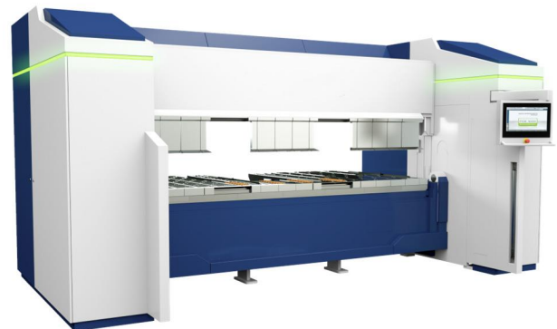
Abbildung 12 – Beispiel Schwenkbiegemaschine, Vorderseite abgesichert mittels Lichtvorhang (grüner Kreis)
