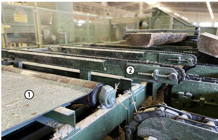
Abb. 49 Querförderer als Winkelübergabe im Abzugsrollengang (obere Endstellung)
