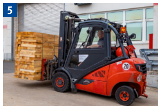
Im Gefälle und in Steigungen Last immer bergseitig führen und nicht wenden.
