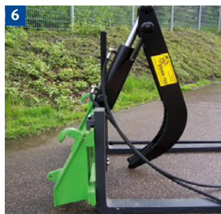
Gabelstapler mit Zangengreifer zum Transport von Rundholz
