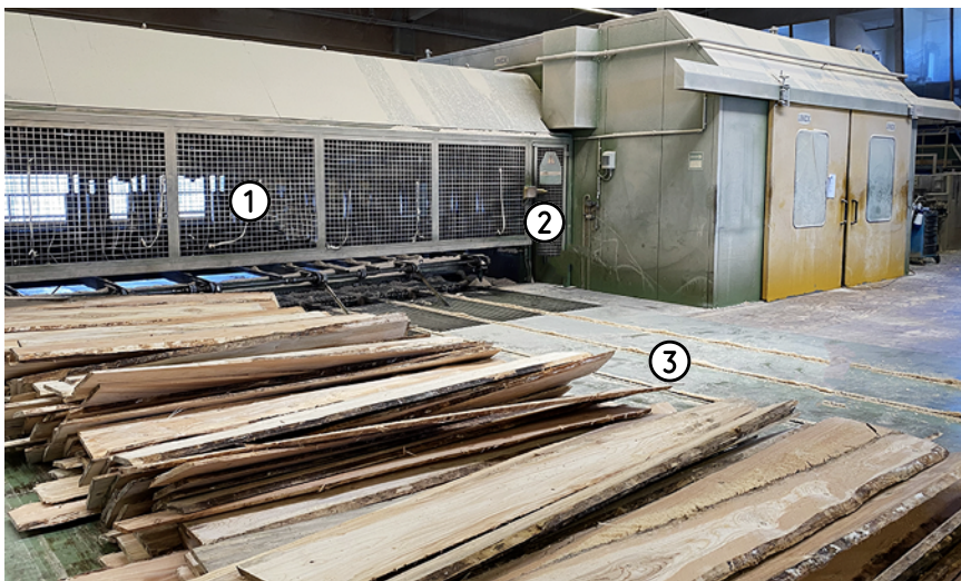
Abb. 51 Ausführungsbeispiel Stetigförderer für Seitenwarenableitungs, um den Zugang zum Gefahrenbereich der Mehrblattkreissäge zu verhindern
