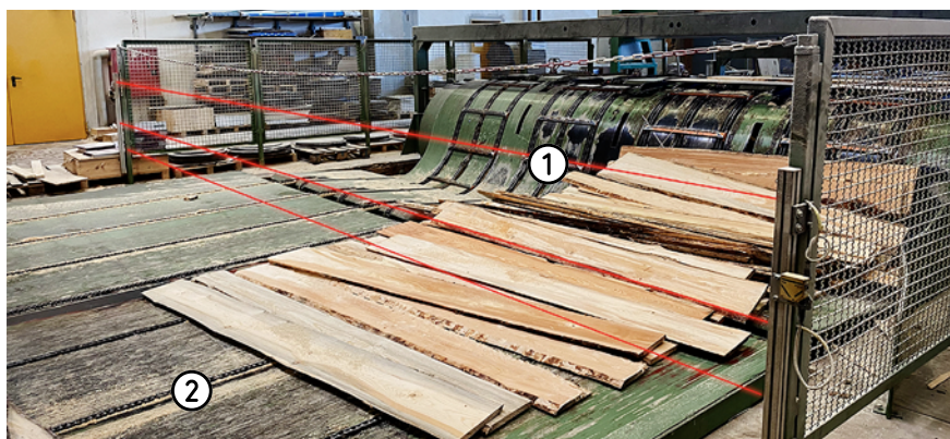
Abb. 47 Ausführungsbeispiel Stetigförderer für Seitenware zwischen Einschnittlinie und Besäumanlage
