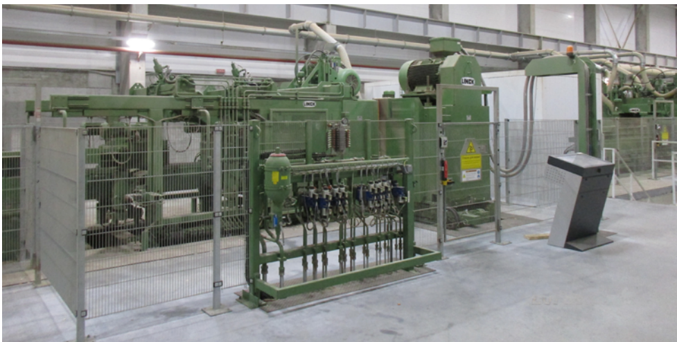
Abb. 1 Stellteile und Bedienpult außerhalb der Gefahrenbereichssicherung
