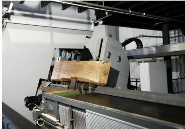
Abb. 17 Blockbandsäge mit automatisch gesteuertem Blockwagen, ohne zwangsläufig gesteuerte Sägeblattverdeckung
