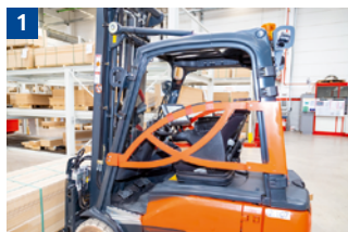
Fahrerückhalteinrichtung (hier: Bügeltür) bei jeder Fahrt benutzen.
