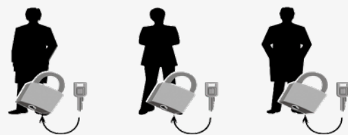
Abb. 8 Eine Person, ein Schloss, ein Schlüssel (Grafik: BGHM); alle Beschäftigten besitzen jeweils ein eigenes Schloss; für jedes Schloss existiert nur ein Schlüssel (außer Ersatz unter Verschluss)
