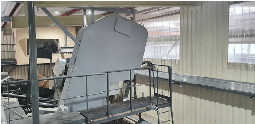
Abb. 12 Einschwenkbares Podest für den Werkzeugwechsel
