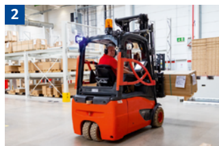
Niemals ohne Sicht fahren. Beim Transport hoher Lasten ausnahmsweise rückwärts fahren oder sich einweisen lassen.
