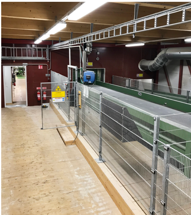
Abb. 32 Beispiel 1, Messplatz mit Gefährbereichssicherung und geöffneter Zugangstür
