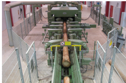
Systemeinzugs- und Zentriereinrichtung vor dem Spanner, Ventilblöcke außerhalb des Gefahrbereichs sowie Gefahrbereichstrennung innerhalb der Anlage
