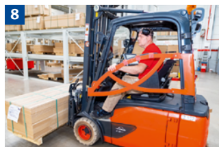
Gabelstapler erst verlassen, wenn der Antrieb stillgesetzt, die Feststellbremse angezogen, die Gabeln auf den Boden gesenkt wurde und der Schlüssel gezogen ist.
