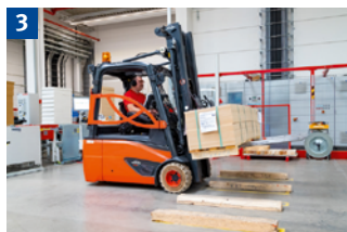
Last am Gabelrücken anlegen, Hubmast nach hinten neigen. Gabelzinken gleichmäßig belasten, in niedriger Stellung verfahren.
