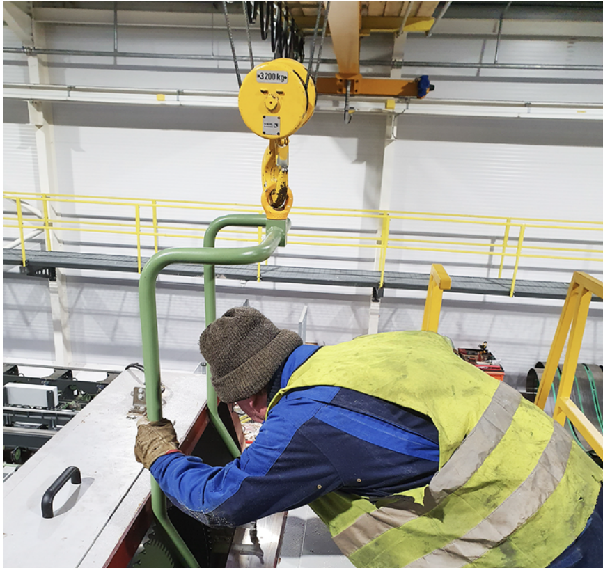
Abb. 11 Werkzeugwechsel mit Hilfsmittel
