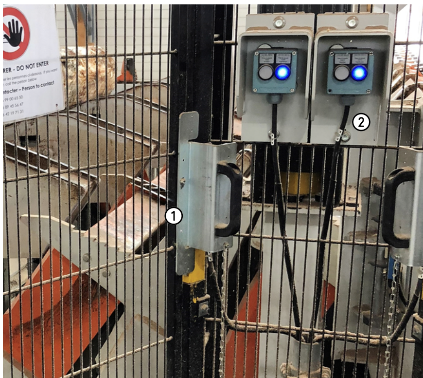
Abb. 53 Verriegelung einer Zugangstür; Verriegelungsschalter muss gegen eine Beschädigung durch herabfallende Werkstücke geschützt sein
