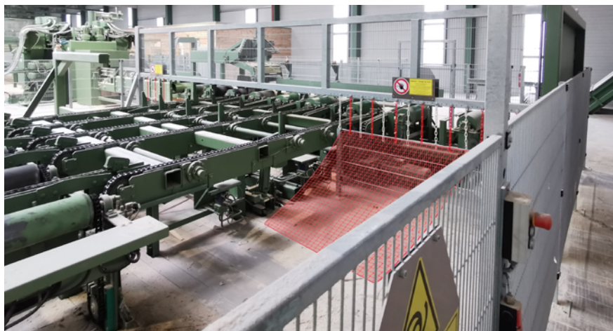
Abb. 4 Schnittstelle zwischen Einschnittlinie und Sortier-Querförderer. Zusätzlich zu dem rot-weißen Kettenvorhang sind weitere sicherheitstechnische Schutzmaßnahmen ggf. nach DIN EN 619 vorzusehen, um ein Übersteigen zu verhindern. Beispielsweise kann ein Stehverhinderer in Form eines gespannten Netzes eingesetzt werden
