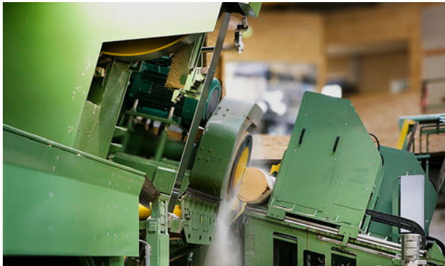
Abb. 38 vorgelagertes Spaneraggregat zur geeigneten Blockbandsäge
