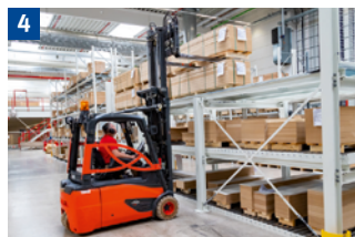
Mit hochgestellter Last nur zum Auf- und Absetzen verfahren. Hubgerüst nur über Stapelfläche nach vorne neigen.
