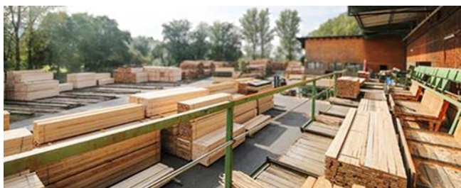
Abb. 58 Geländer mit herausnehmbarer Knieleiste zum Abtransport des Schnittholzes
