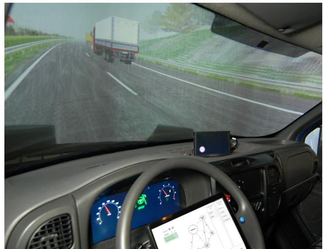
Umgebautes Cockpit des dynamischen Fahrsimulators im Level-3 -Automatikmodus. Im Lenkrad eingebaut ist das Tablet für die Nebenaufgaben. © IAG
