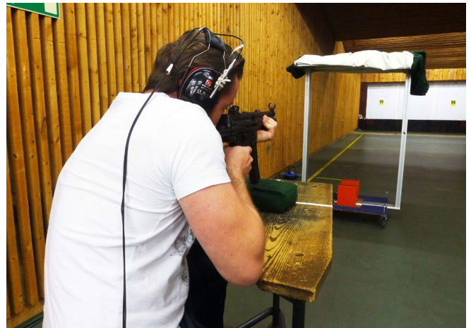
Messaufbau zur Bestimmung der Lärmexposition des Schützen
