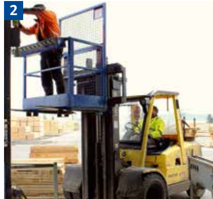
Instandhaltungsarbeiten mit Gabelstapler und Arbeitsbühne.
