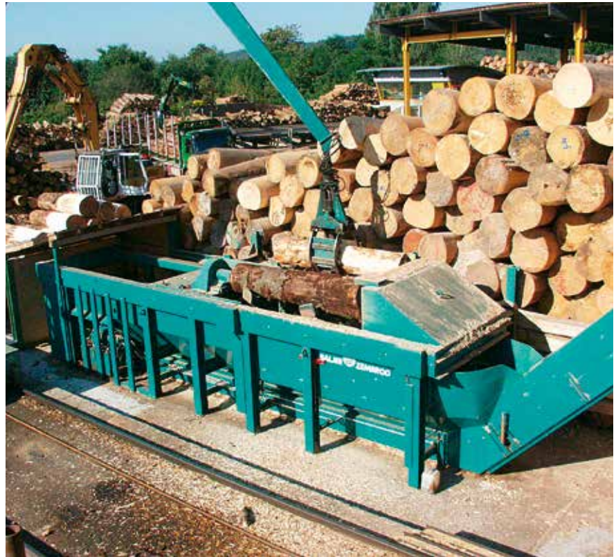
Bild 6: Beispiel für Sicherungsvariante 1: Gefahrbereichssicherung durch Verblechungen
