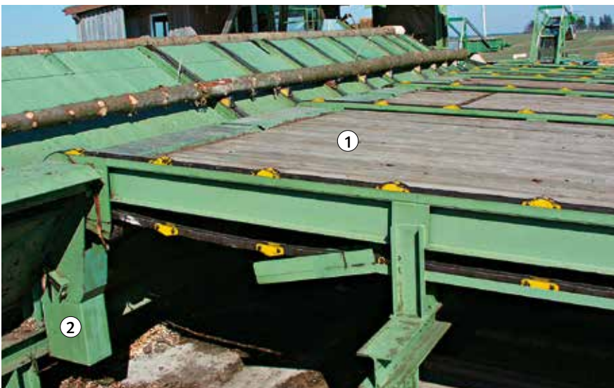
Bild 11: Beispiel für Sicherungsvariante 1: Rundholz-Aufgabe-Querförderer mit Vereinzeln
