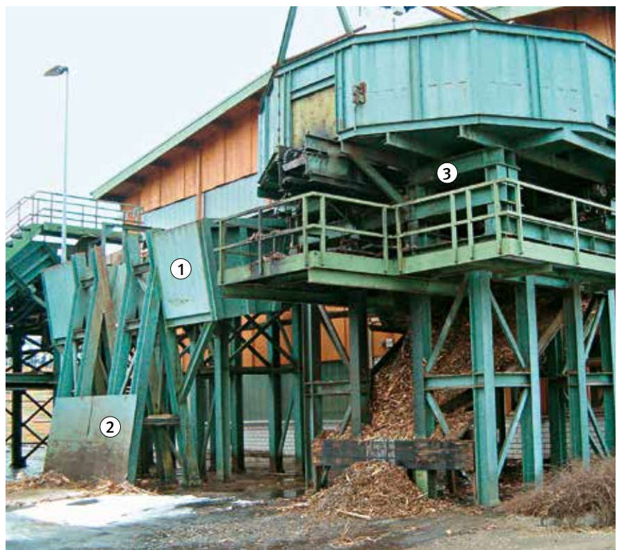
Bild 41: Rundholzzubringung mit Aussortierbox
