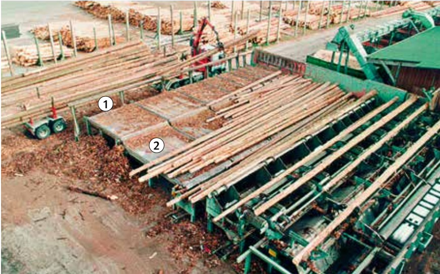
Bild 10: Beispiel für Sicherungsvariante 1: Langholz-Aufgabe-Querförderer
