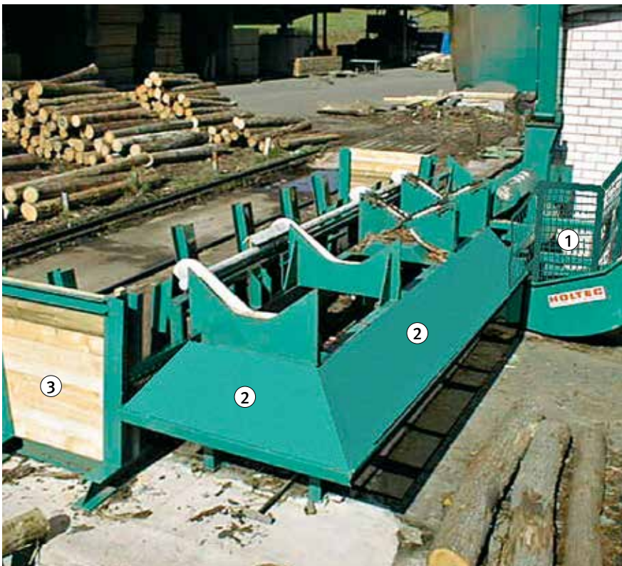
Bild 8: Beispiel für Sicherungsvariante 2: Sicherung des Wurzelreduzierers durch distanzierende Schutzeinrichtungen
