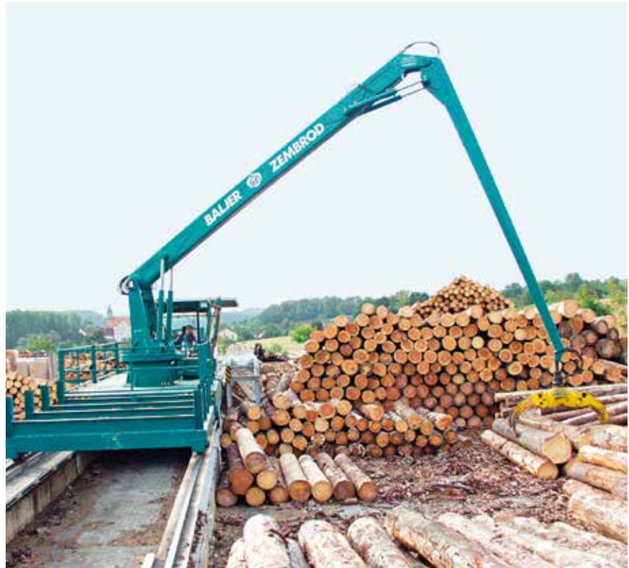
Bild 4: Rundholzsortierkran mit Absturzsicherung an der Kranplattform durch Geländer
