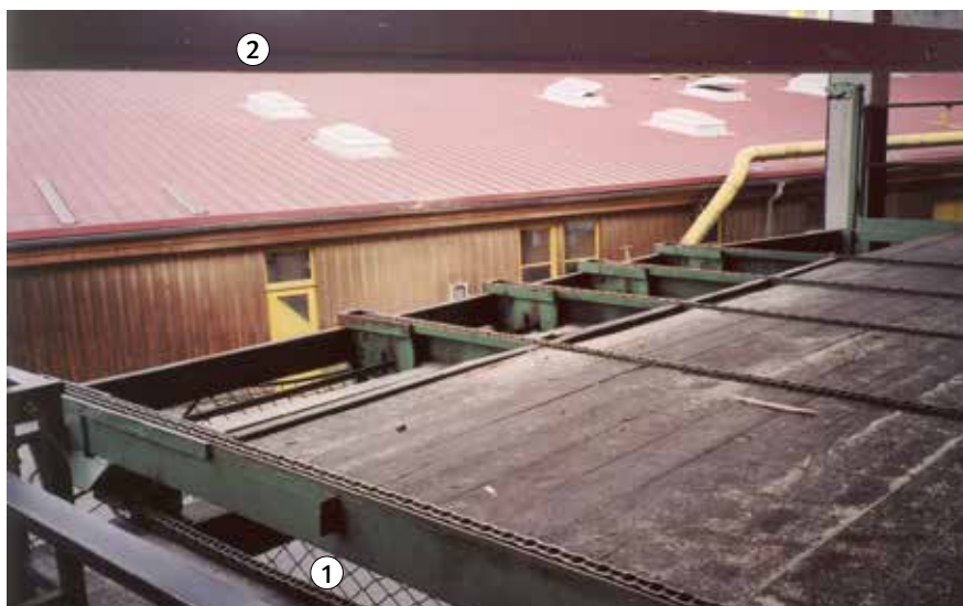
Bild 44: Absturzsicherung an erhöhten Stapelbereichen
