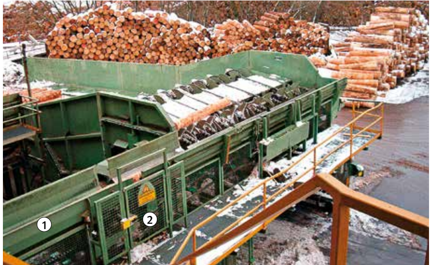
Bild 44: Aufgabequerförderer, Vereinzelter, Stammeinleger und Blockzug zur Sägehalle
