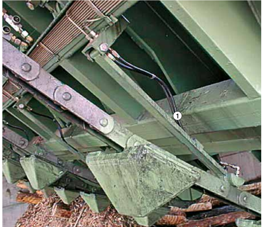
Bild 34: Zentralschmierung an der Förderkette eines Vereinzelners
