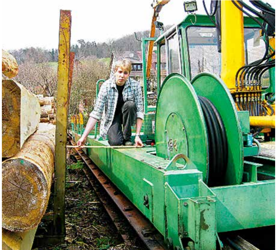
Bild 5: Sicherheitsabstand (mind. 0,5 m) zwischen Rundholzsortierkran und Polterstützen
