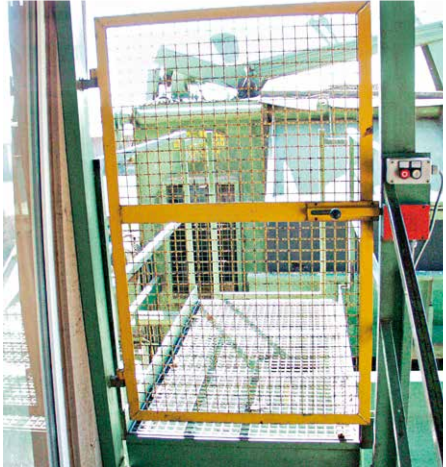
Bild 15: Elektrisch verriegelte Zugangstür zum Förderbereich von Rundholzaufgabe, Fallstufe, Vereinzeln und Stammeinleger
