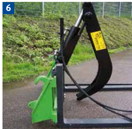
Gabelstapler mit Zangengreifer zum Transport von Rundholz.
