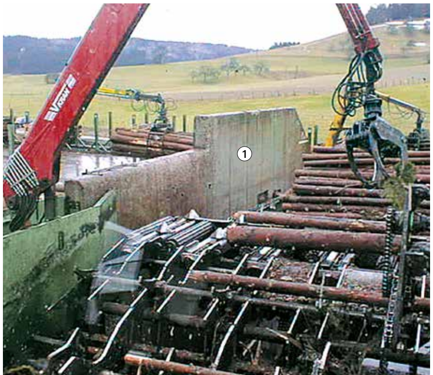
Bild 16: Manipulator macht Einsteigen zur Störungsbeseitigung nicht mehr notwendig
