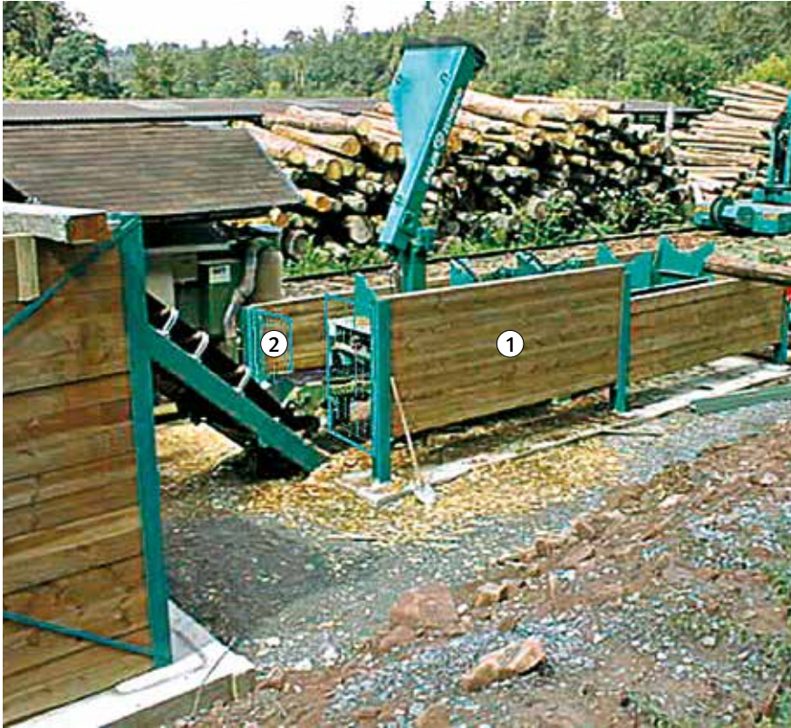
Bild 7: Beispiel für Sicherungsvariante 1: Gefahrbereichssicherung durch Spundwände
