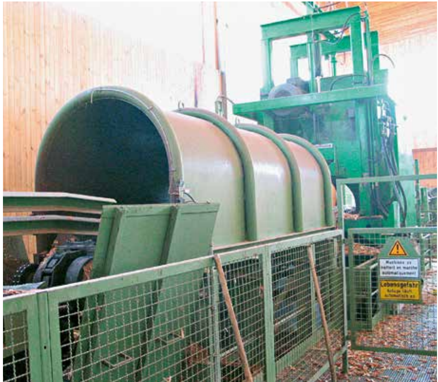
Bild 21: Entrindungsanlage mit Schutzbügel gegen herumschlagende Stämme und Umzäunung mit elektrisch verriegelter Zugangstür und Zuhaltung
