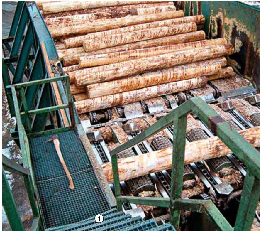
Bild 37: Aufgabe-Querförderer, Ausrichtrollengang und Vereinzeln
