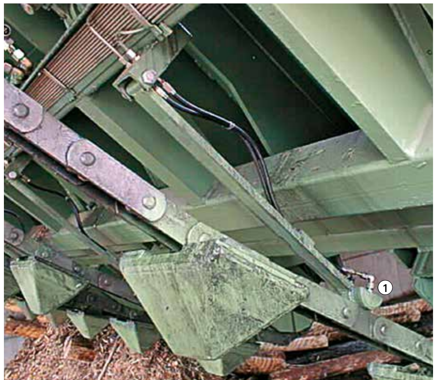
Bild 40: Zentralschmierung am rücklaufenden Kettenstrang eines Vereinzelners
