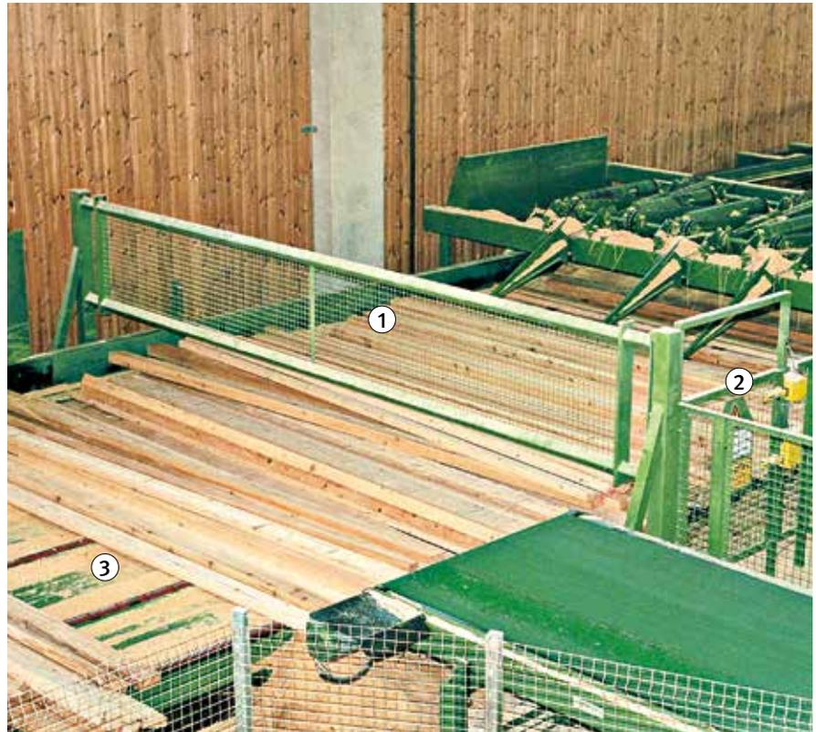
**Bild 31:** Ausführungsbeispiel Stetigförderer für Seitenware zwischen Einschnittlinie und Besäumanlage
