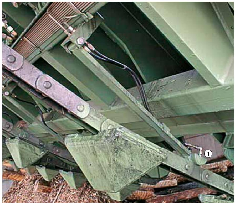
Bild 40: Zentralschmierung am rücklaufenden Kettenstrang eines Vereinzelners
