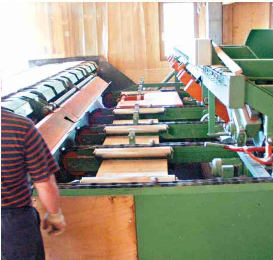
Bild 14: Auskleidungen innerhalb der Förderebene des Querförderers zur Kappanlage als begehbare Fläche zur Störungsbeseitigung sowie zu Rüst- und Instandhaltungsarbeiten
