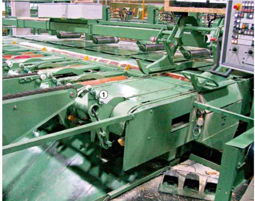
Bild 10: Durchlaufkappanlage
