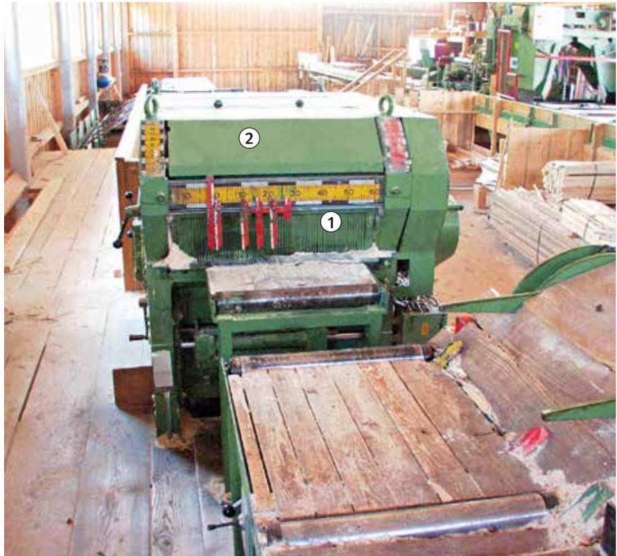
Bild 5: Einschubseite einer handbeschickten Mehrblattkreissägemaschine mit Walzenvoranschub
