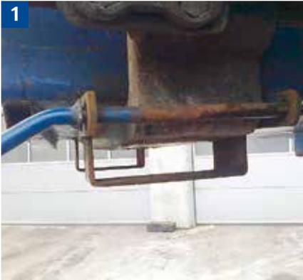
Arbeitsbühne gegen Abkippen und Abrutschen formschlüssig sichern (Steckbolzen mit Splint gesichert).
