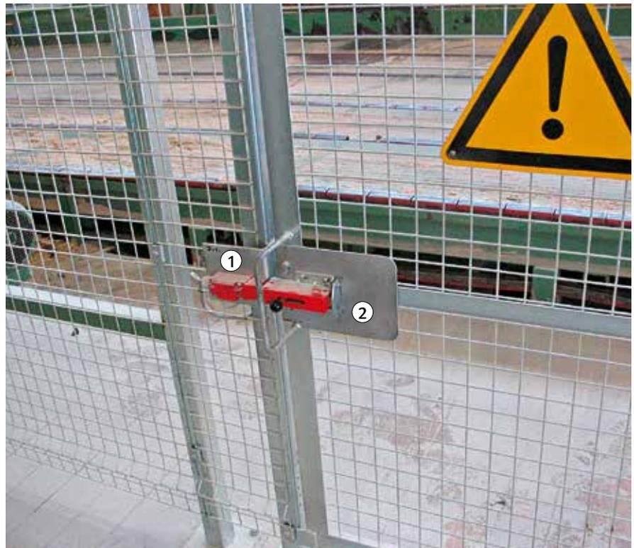
Bild 41: Elektrisch verriegelte Zugangstür
