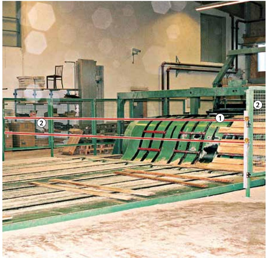
Bild 22: Sicherung eines Vereinzelners oberhalb der Förderebene
