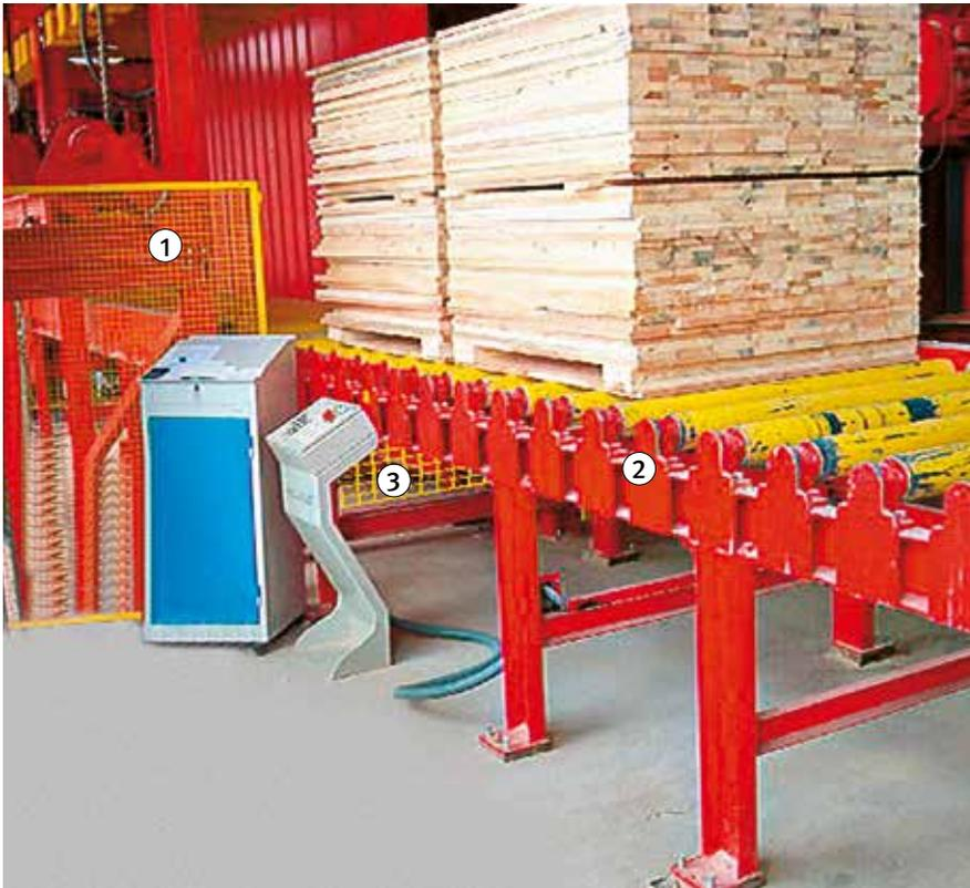
Bild 32: Ausführungsbeispiel Rollengang als Teil der Zugangssicherung zum Gefahrenbereich einer Stapelanlage
