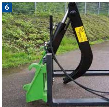
Gabelstapler mit Zangengreifer zum Transport von Rundholz.
