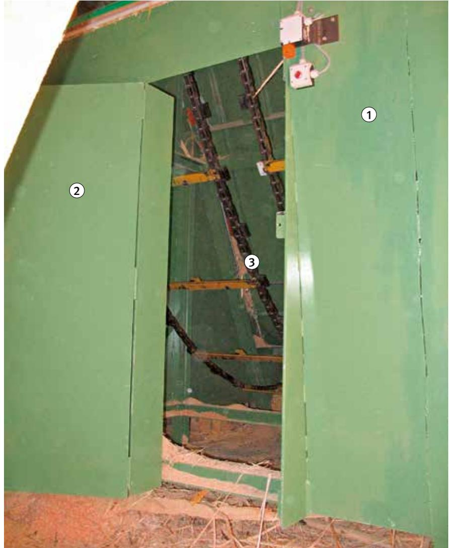
Bild 9: Gefahrbereichssicherung eines Vereinzelners unterhalb der Förderebene
