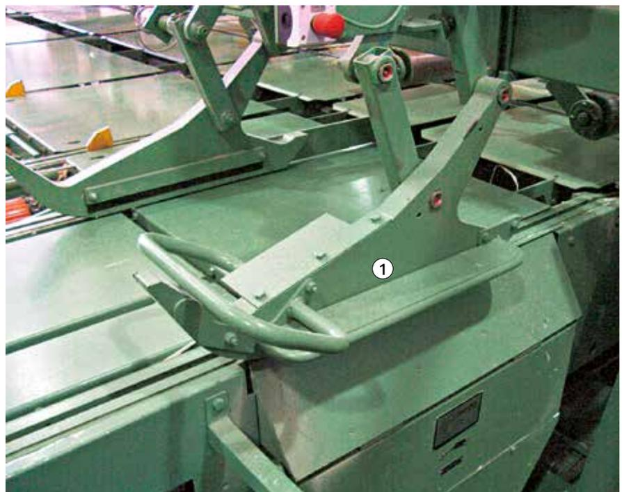
Bild 11: Durchlaufkappanlage
