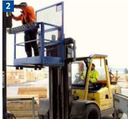
Instandhaltungsarbeiten mit Gabelstapler und Arbeitsbühne.
