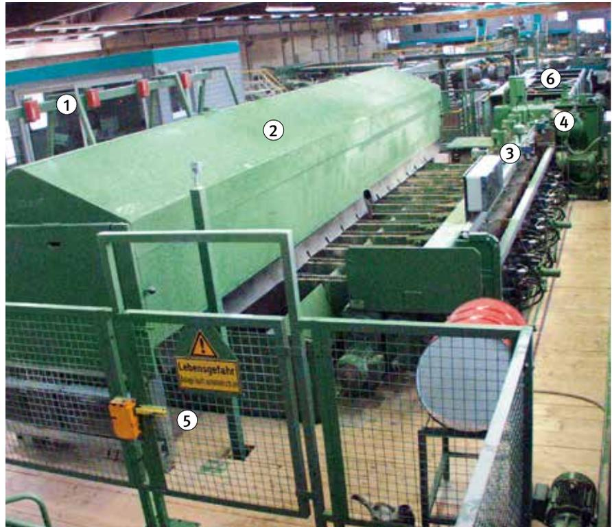
Bild 25: Anlagenbereich Vermessung, Trimmer-Kappsägen, Einzugs- und Zentrierwerk, Besäumsäge und tunnelförmiger Ausschubbereich mit Leit- und Fangeinrichtungen (siehe auch Bild 26 auf Seite 30)
