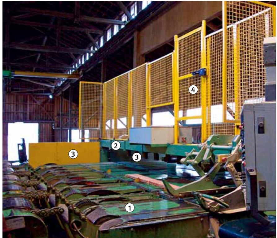
Bild 16: Halbautomatische Kapp- und Besäumanlage, Bearbeitung im Gegenlauf ohne Rückschlagsicherung
