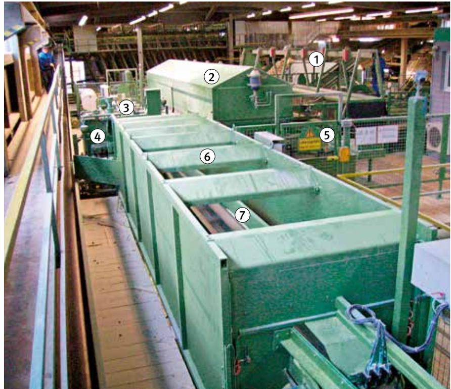
Bild 26: Anlagenbereich Vermessung, Trimmer-Kappsägen, Einzugs- und Zentrierwerk, Besäumsäge und tunnelförmiger Ausschubbereich mit Leit- und Fangeinrichtungen
