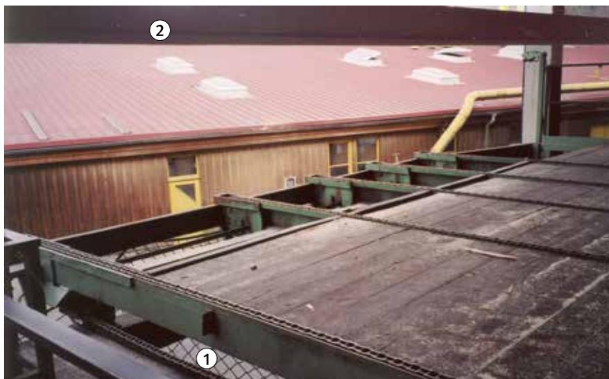
Bild 44: Absturzsicherung an erhöhten Stapelbereichen
