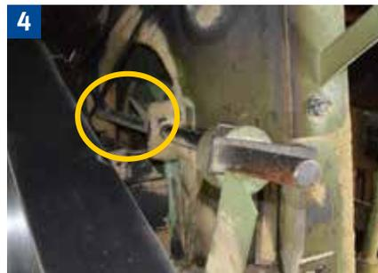
Formschlüssige Sicherung gegen Herabsinken des Sägerahmens.
