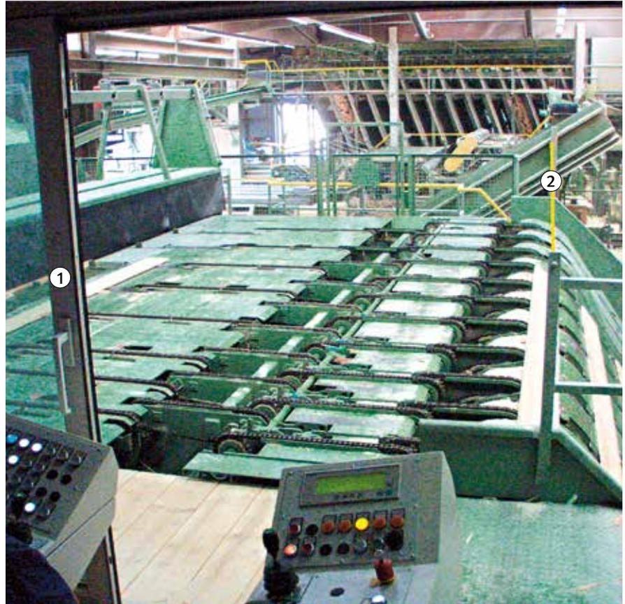
Bild 23: Querförderung, Brettwender, Ausschussklappe, Ausrichtrollengang
