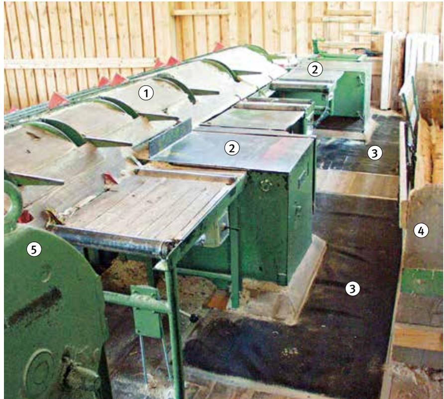
Bild 4: Untertischkappkreissägemaschine mit Schutzgitter nach EN 1870-10
