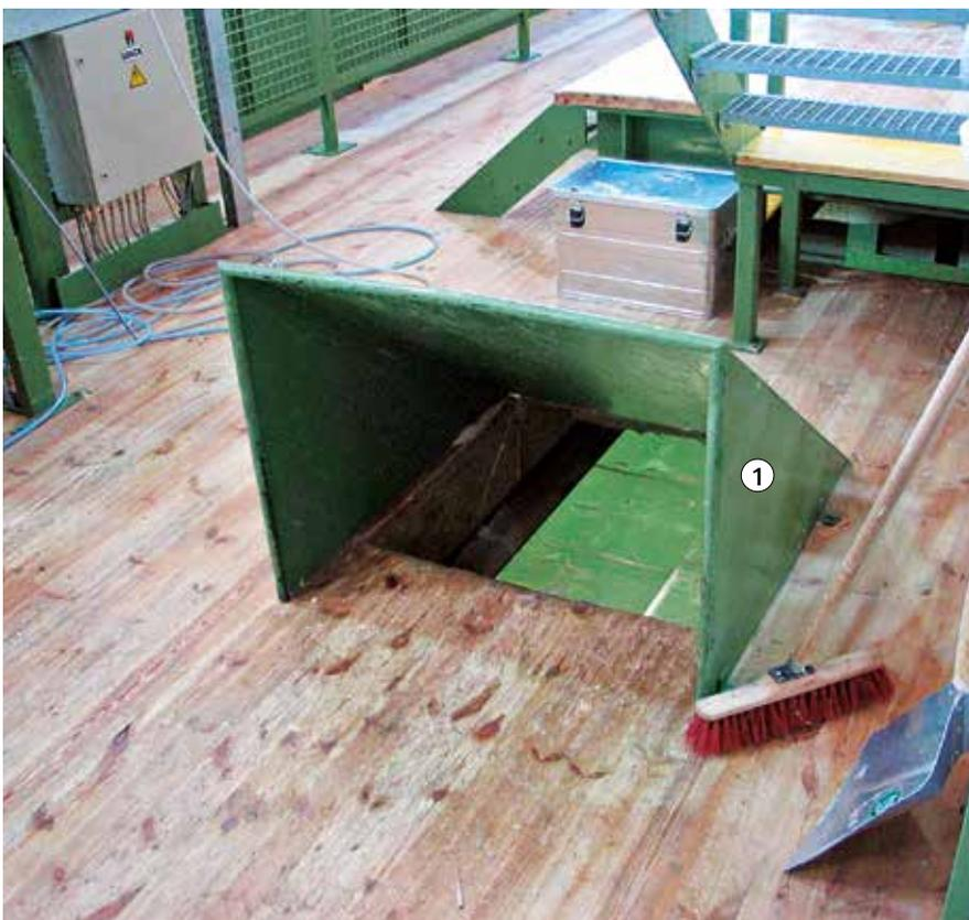
Bild 15: Abwurföffnung für Reststücke aus der Durchlaufkappanlage
