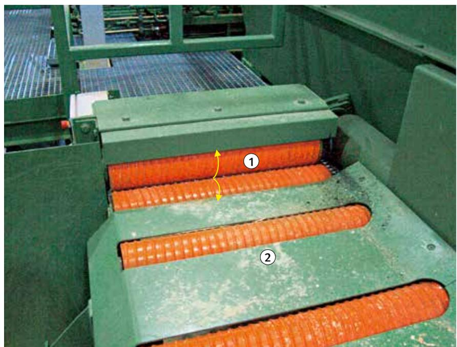
Bild 7: Vermeidung der Einzugsgefahr an übereinander angeordneten Spiralrollen zum Abziehen der Spreißel durch gegenläufige Drehrichtung
