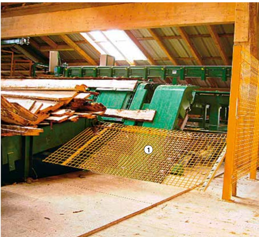
Bild 33: Ausführungsbeispiel einer abweisenden Baustahlmatte als Teil der Zugangssicherung zum Gefahrenbereich einer Vereinzellung
