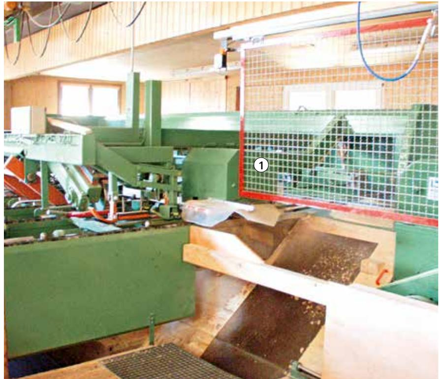
Bild 17: Anlagenbereich Durchlaufkappung und Einzugs- und Zentriereinrichtung zur Besäumung
