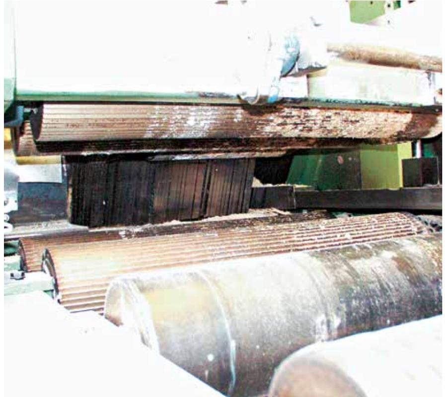
Bild 19: Mehrblattkreissägemaschine mit Bearbeitung im Gleichlauf
