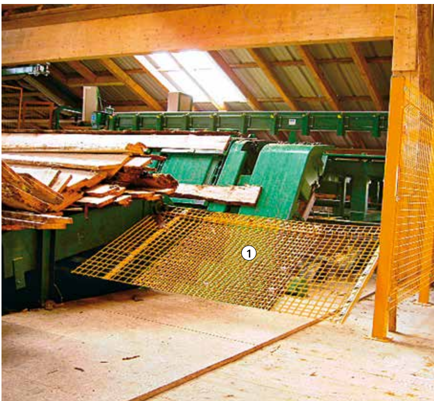
Bild 40: Ausführungsbeispiel einer abweisenden Baustahlmatte als Teil der Zugangssicherung zum Gefahrenbereich einer Vereinzellung
