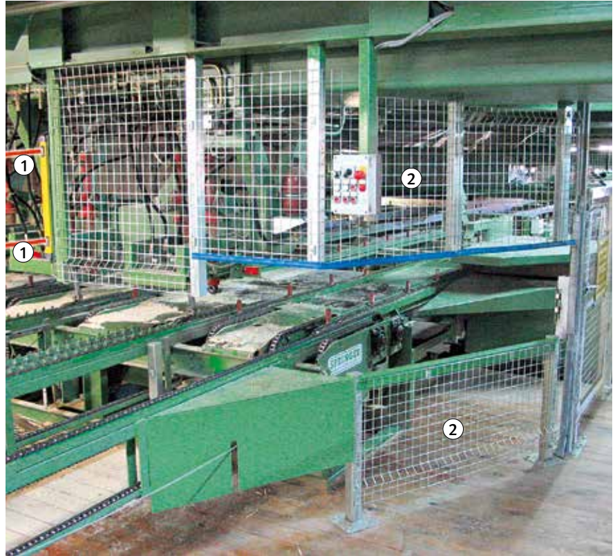
Bild 16: Unterer Beurteilungsförderer mit Einlauf zum Zuteiler und zur Wurzelkappsäge
