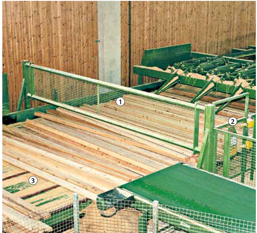
Bild 37: Ausführungsbeispiel Stetigförderer für Seitenwarenabtransport, um den Zugang zum Gefahrenbereich der Einschnittlinie zu verhindern
