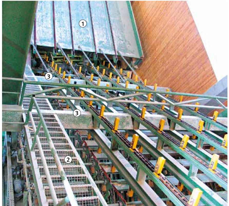
Bild 22: Sortierförderer einer Horizontal-Etagen-Sortieranlage (wie Bild 20 auf Seite 25, jedoch Blick von oben nach unten)
