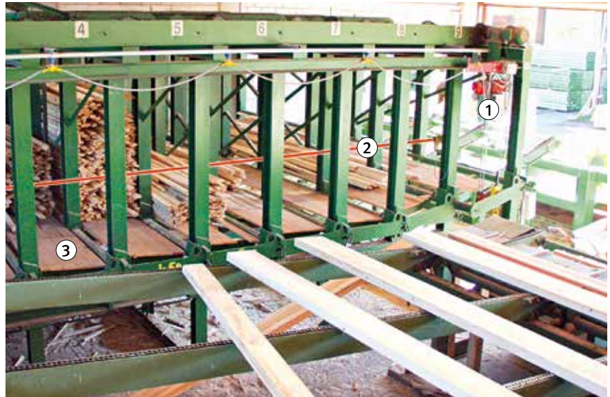
Bild 8: Quersortieranlage mit schwenkbaren Sortierboxenböden
