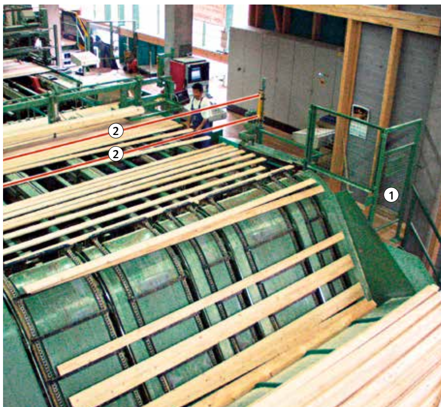
Bild 26: Anlagenbereich Vereinzelner, Ausrichtrollengang und Lagenbildung
