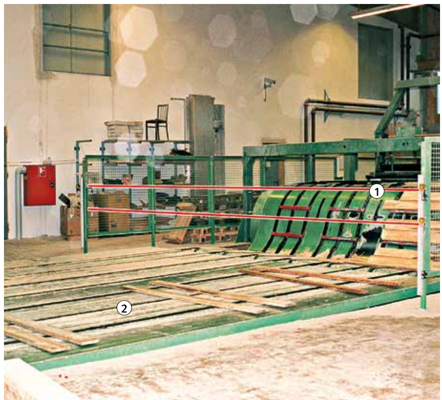
Bild 38: Ausführungsbeispiel Stetigförderer für Seitenware zwischen Einschnittlinie und Besäumanlage
