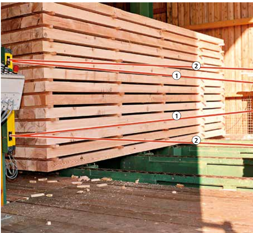
Bild 31: Abtransport aus einer Stapelanlage (siehe auch Bild 30)
