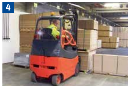
4 Niemals ohne Sicht fahren. Ausnahmeweise beim Transport hoher Lasten rückwärtsfahren oder Einweiser zu Hilfe nehmen.
