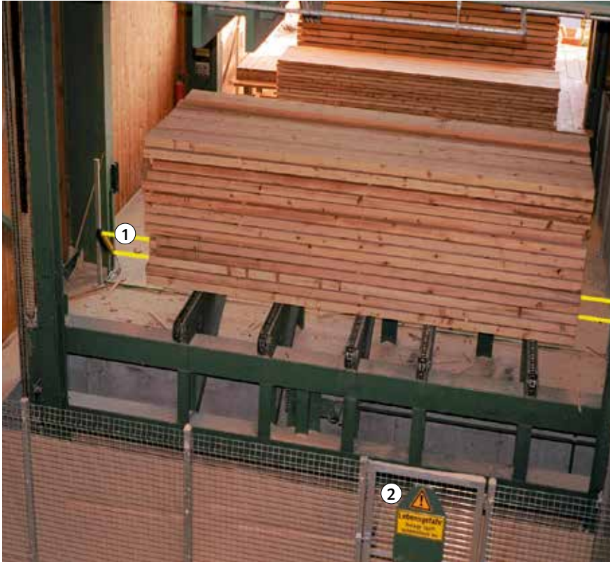
Bild 30: Abtransport aus einer Stapelanlage (siehe auch Bild 31)
