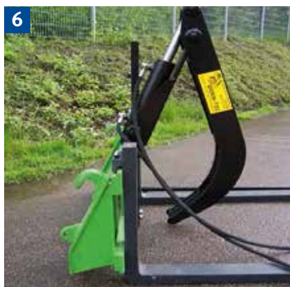
Gabelstapler mit Zangengreifer zum Transport von Rundholz.
