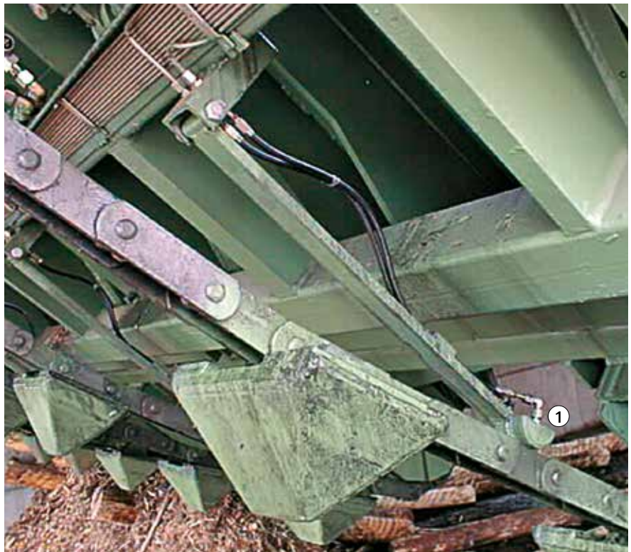
Bild 40: Zentralschmierung am rücklaufenden Kettenstrang eines Vereinzelners
