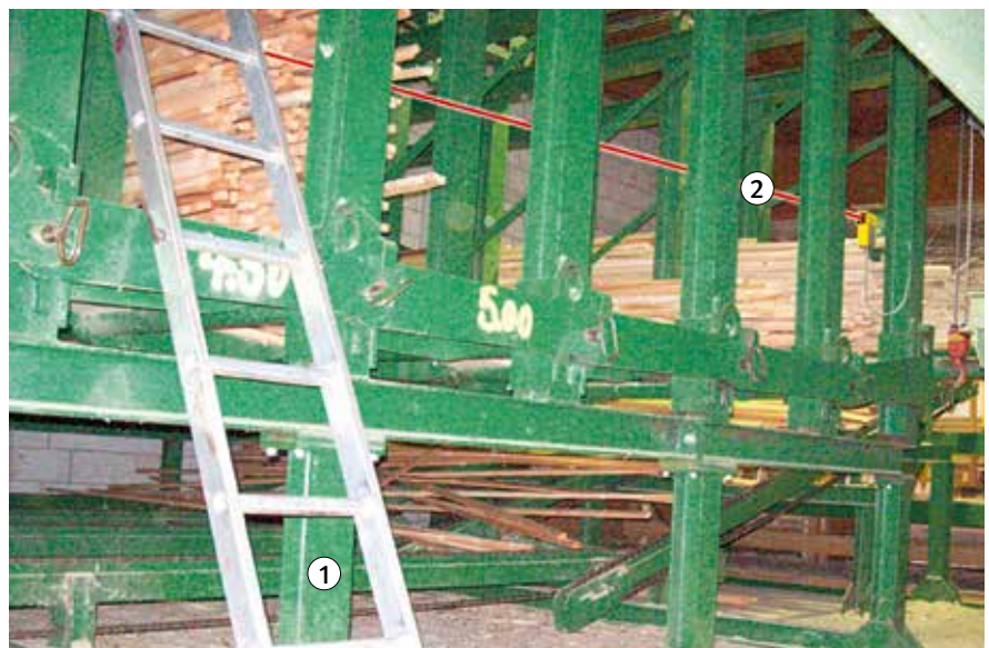
Bild 9: Quersortieranlage mit schwenkbaren Sortierboxenböden
