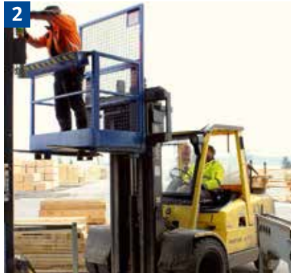
Instandhaltungsarbeiten mit Gabelstapler und Arbeitsbühne.
