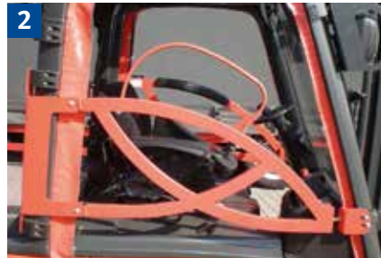
2 Fahrerrückhalteeinrichtung (z. B. Fahrersitzgurt oder Bügeltür) bei jeder Fahrt benutzen.
