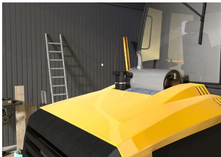
Abb. 9 Nachrüstung eines Dieselpartikelfilters
