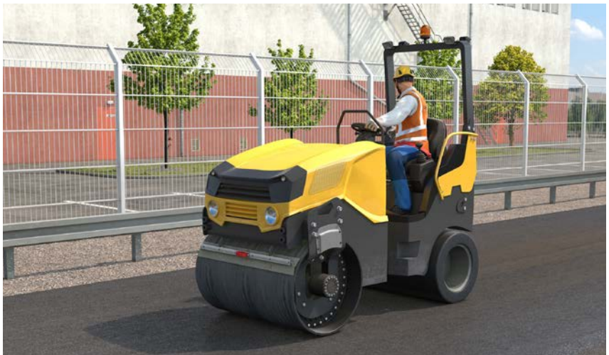
Abb. 12 Überrollschutzeinrichtung und Sicherheitsgurt bieten Schutz bei Umsturz
