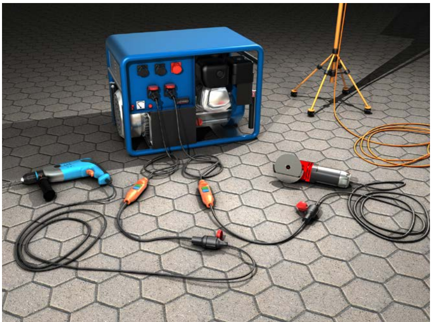
Abb. 5 Betrieb sämtlicher Betriebsmittel über jeweils eine PRCD
