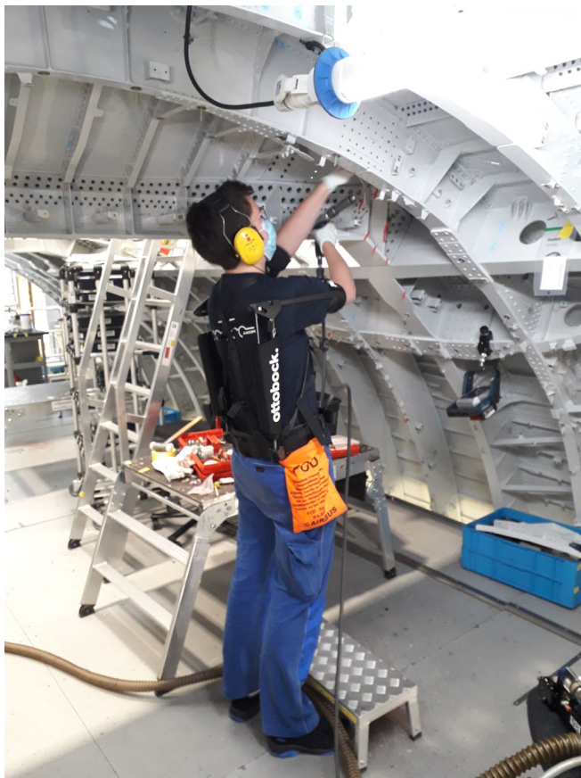
Nutzung eines schulterunterstützenden Exoskelettes bei Über-Schulter-Montagetätigkeiten im Flugzeugbau. Foto: Airbus Defence & Space GmbH
