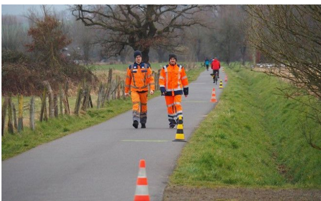
Feldversuch: Fluoreszierend orange-rote Warnkleidung im neuen und getragenen Zustand
