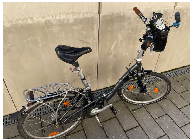
Untersuchung der Vibrationen auf dem Sattel und Lenkergriffen
