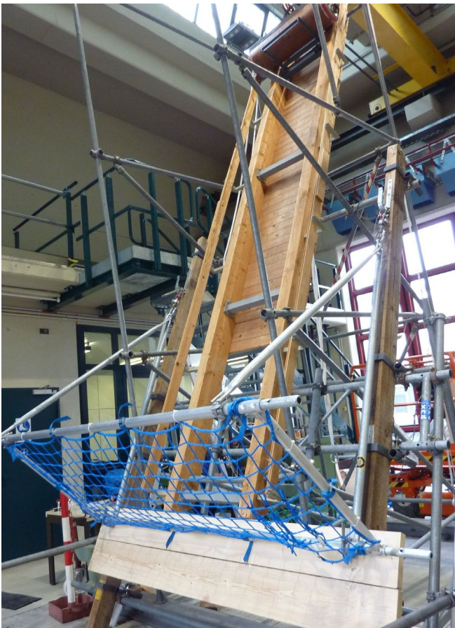
Modifizierter Prüfstand für Abrollversuche mit Dachschutzwand
