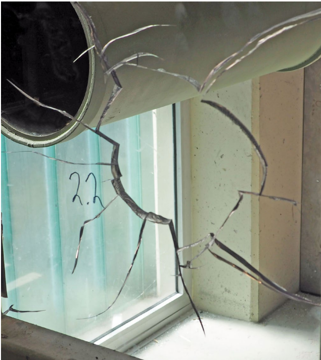
Beschichtete Polycarbonatscheibe mit Sprödbbruch
