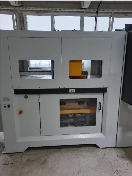
Bild 2: Verriegelte Türen an der automatisierten Plattenzufuhr
