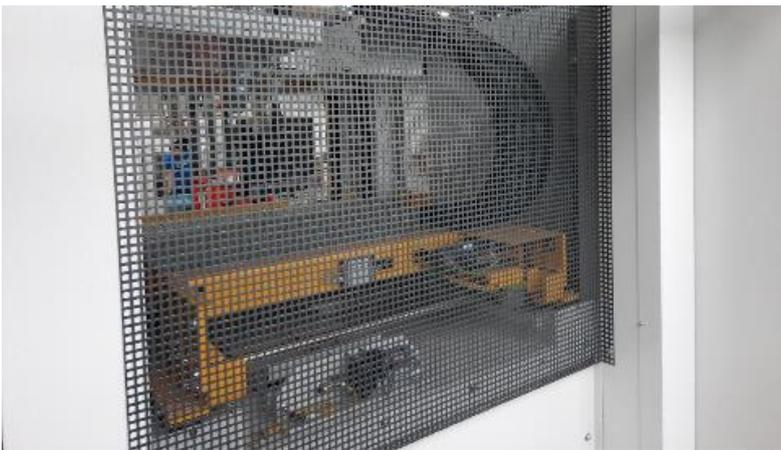
Bild 1: Fest installierte trennende Schutzeinrichtung im rückwärtigen Bereich der Warmformmaschine
