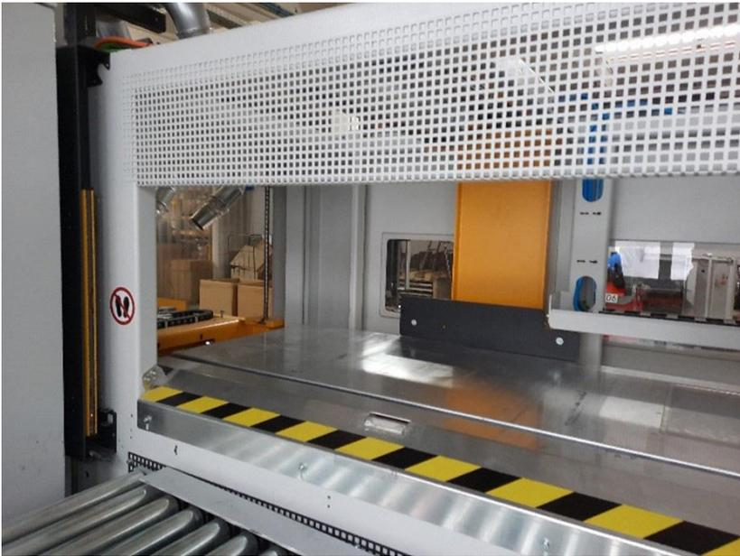
Bild 4: Austragsseite mit sensibler Schutzeinrichtung („Lichtvorhang“)
