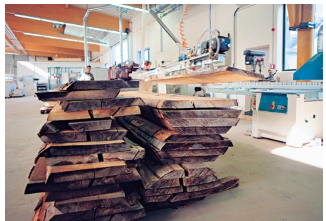
Abb. 48 Vakuumheber für Schnittholz
