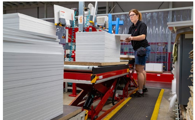
Abb. 6 Scherenhubtisch zur Anpassung der Arbeitshöhe
