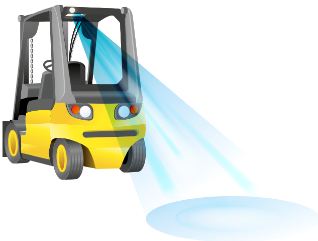
Abb. 41 Stapler mit optischer Fahrweg-Warnerichtung
