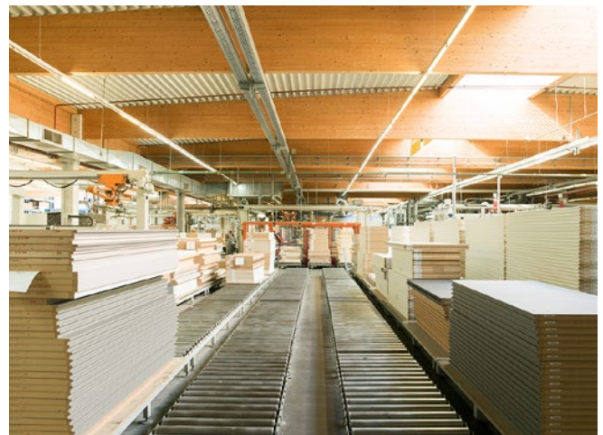
Abb. 9 Anlieferung der Werkstücke über Rollenbahnen
