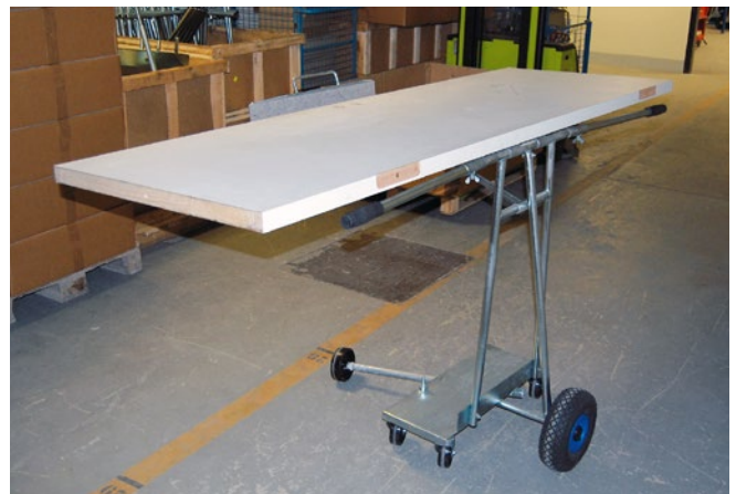
Abb. 32 Plattenschwenkwagen – Platte waagrecht geschwenkt
