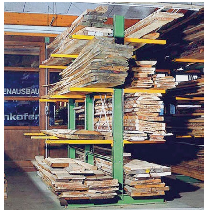
Abb. 64 Kragarmregal (mit Teleskoparmen für Schnittholz)
