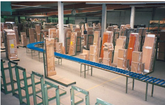
Abb. 2 Rollenbahn im Kommissionierbereich
