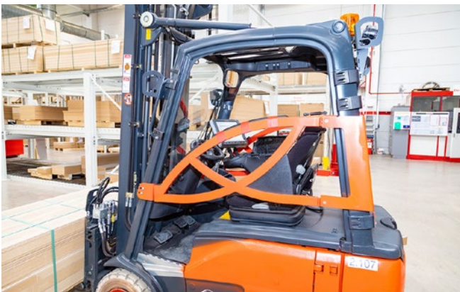
Abb. 17 Fahrerrückhalteeinrichtung (hier: Bügeltür) bei jeder Fahrt benutzen
