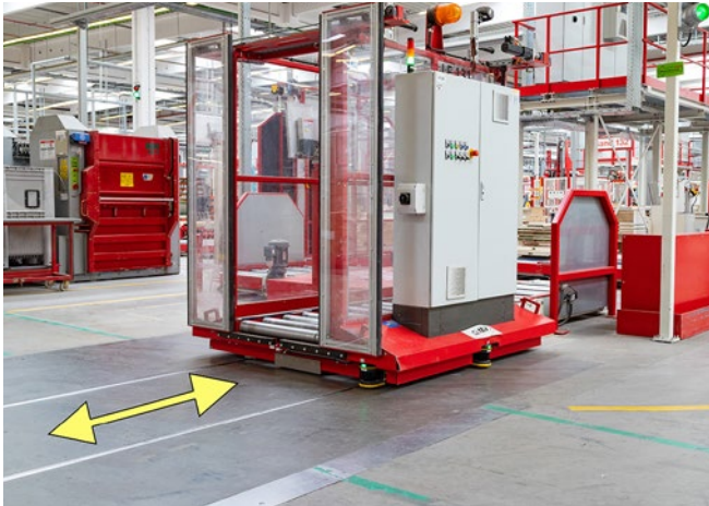
Abb. 86 Längsverschiebewagen mit Laserscanner
