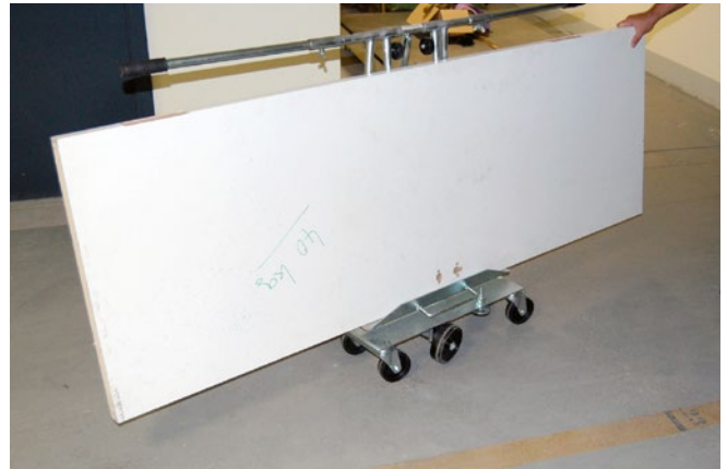
Abb. 31 Plattenschwenkwagen – Platte senkrecht in Transportposition
