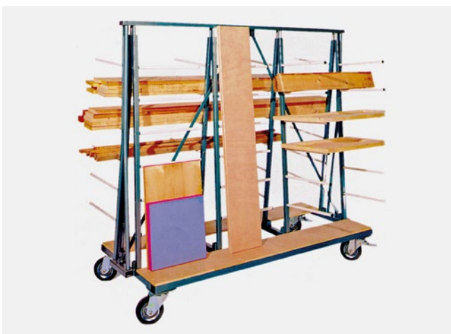
Abb. 26 Durch Plattentransportwagen entfällt manuelles Heben und Tragen
