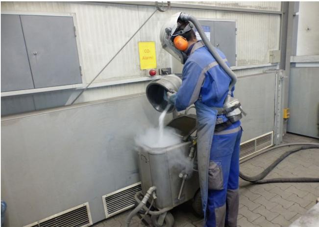
Abb. 12.16 In einem Arbeitsraum mit technischer Lüftung durch Absaugung im Bodenbereich füllt ein Mitarbeiter mit persönlicher Schutzausrüstung Trockeneis um
