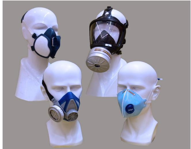
Abb. 15.1 Darstellung einer partikelfiltrierenden Halbmaske sowie von Voll- und Halbmasken mit Partikelfilter
