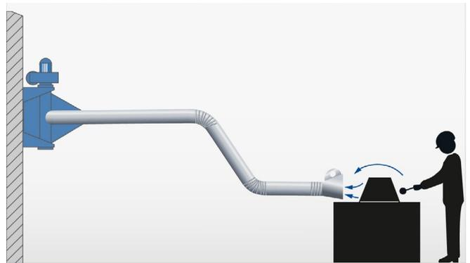
Abb. 12.10 Technische Lüftung an Handlaminierarbeitsplätzen: Abgesaugter Arbeitstisch (oben) und nachführbare Absaugung (unten)
