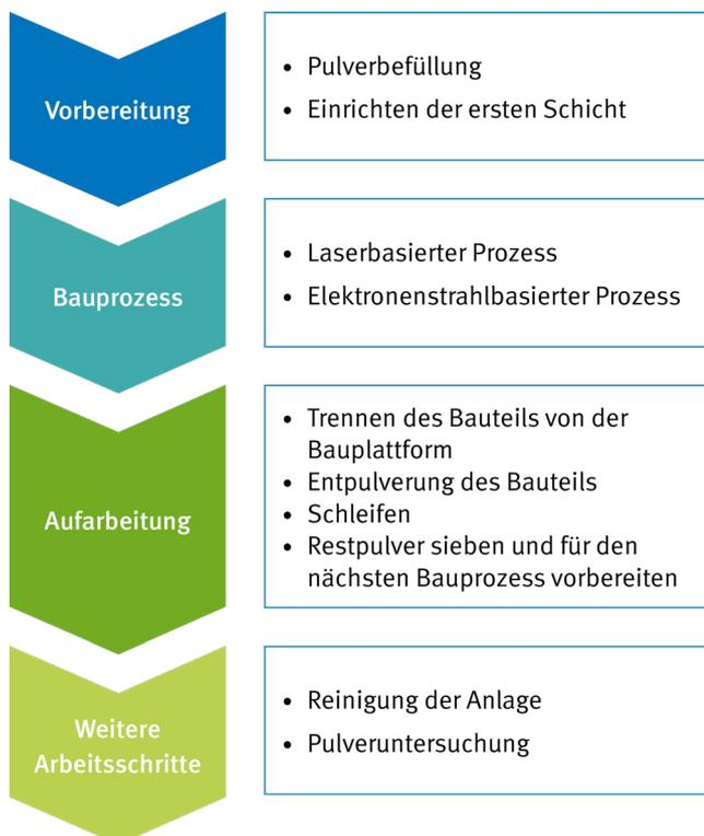
Abb. 12.18 Typische Arbeitsschritte bei pulverbettbasierten additiven Fertigungsverfahren
