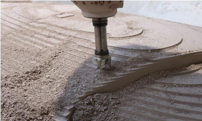
Abb. 12.24 Staubentwicklung beim Fräsen einer Modelloberfläche
