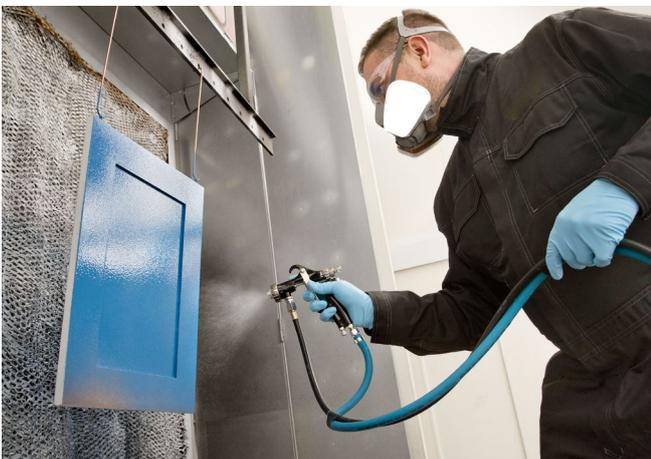
Abb. 12.2 Lackierer beschichtet ein Werkstück an einer Spritzwand im Sprühverfahren
