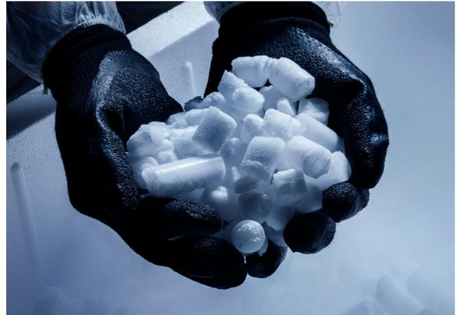
Abb. 12.15 Entnahme von Trockeneispellets aus einem isolierten Behälter.
