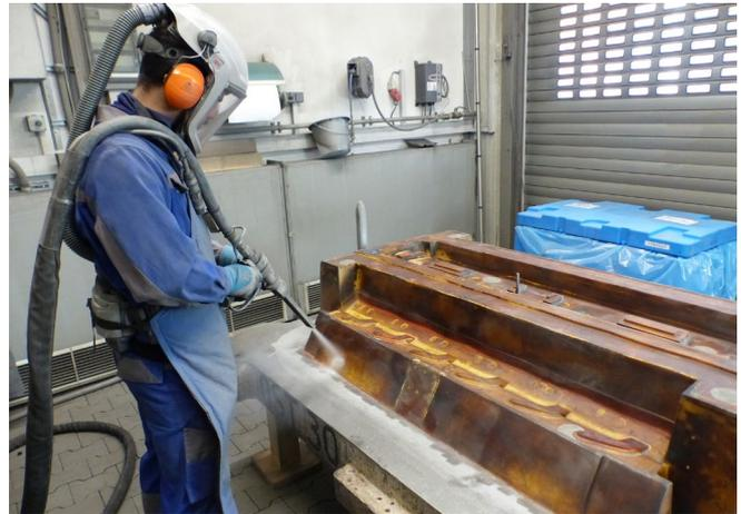
Abb. 12.17 In einem Arbeitsraum mit technischer Lüftung durch Absaugung im Bodenbereich reinigt ein Mitarbeiter mit persönlicher Schutzausrüstung einen Formkasten durch Strahlen mit Trockeneis
