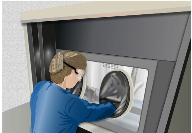
Abb. 12.22 Mitarbeiterin arbeitet mit Metallpulvern in einer Handschuhbox
