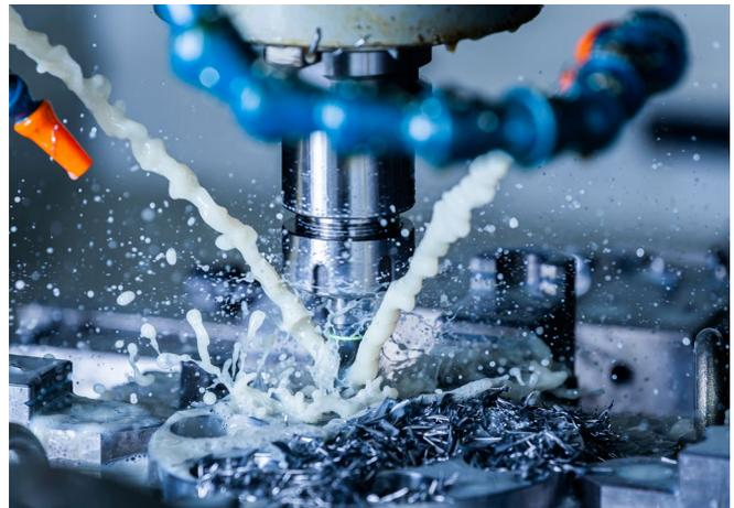
Abb. 12.13 Metallisches Werkstück wird mit Werkzeug gefräst und dabei mit Kühlschmierstoff beaufschlagt
