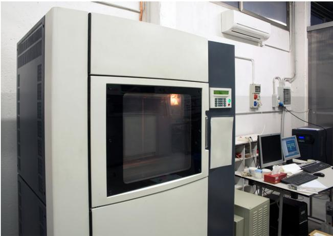
Abb. 12.21 Anlage für pulverbettbasierte Schmelzverfahren
