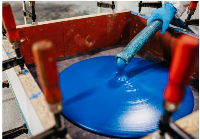
Abb. 12.6 Polyurethan (PUR)-Harz wird aus einem Schlauch in eine Form gegossen.
