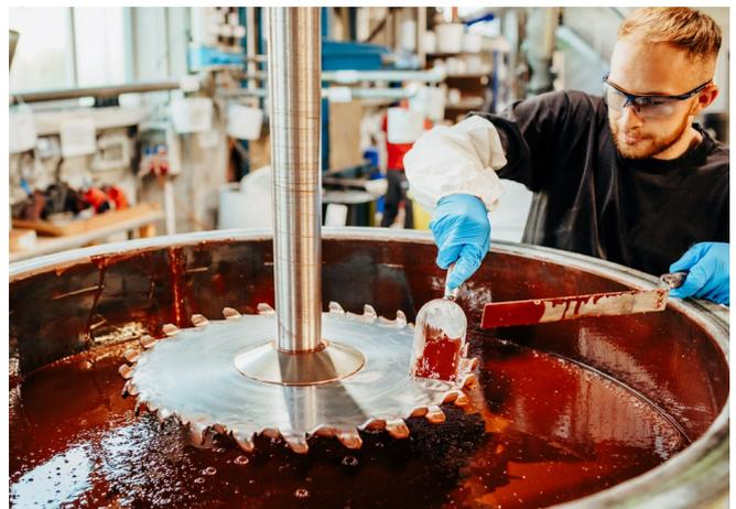
Abb. 12.8 Reinigung des Rührwerks an einem Mischkessel mit Polyurethan (PUR)-Harz.
