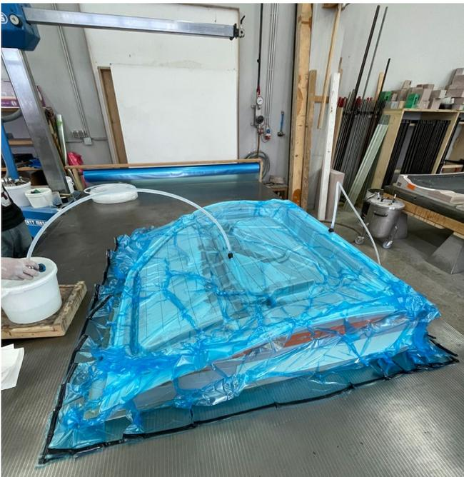
Abb. 12.9 Vakuuminfusionsverfahren: Das Harz wird mithilfe von Unterdruck über einen Kunststoffschlauch aus der Mischvorlage in die Form befördert.
