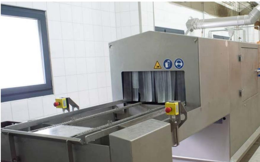
Abb. 64 Durchlaufspülmaschine für die Reinigung von z. B. Kisten oder Körben
