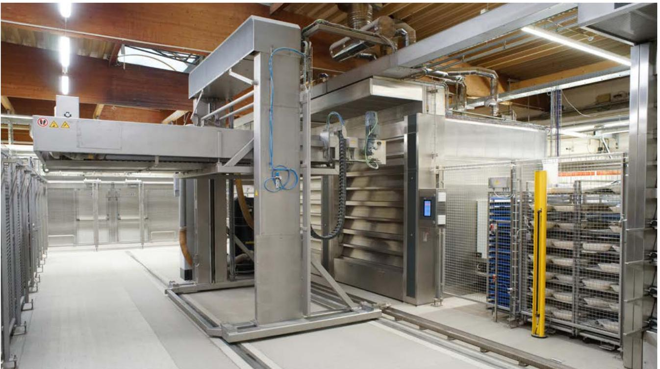
**Abb. 53** Vollautomatischer Ofenlader für die Beschickung mehrerer Etagenbacköfen
