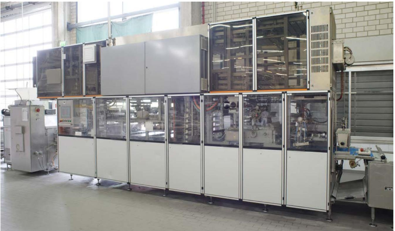
**Abb. 29** Brötchenanlage, bestehend aus Kopfmaschine und Zwischengärschrank
