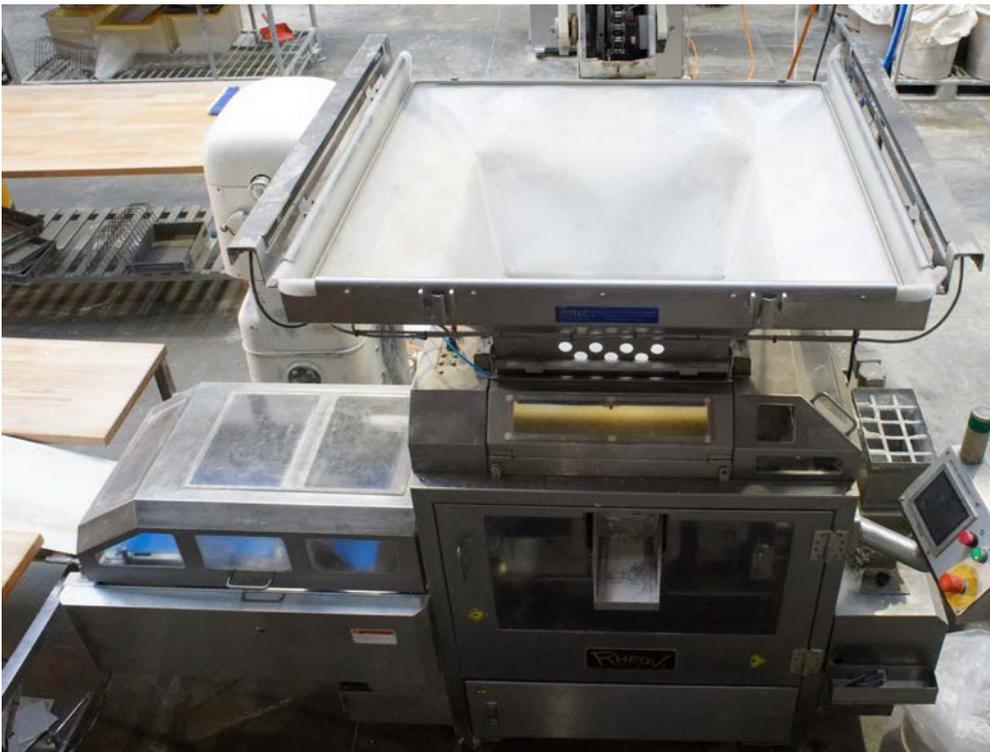
Abb. 17 Teigteilmaschine mit Trichter
