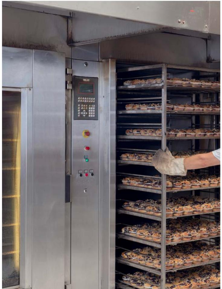
Abb. 48 Beschickung eines Wagenbackofens
