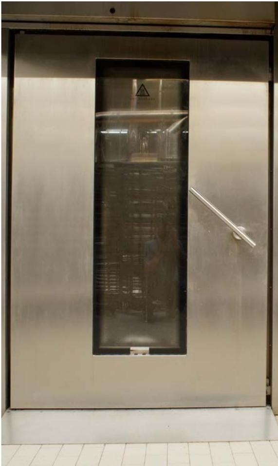
Abb. 47 Stikkenbackofen mit Rampe
