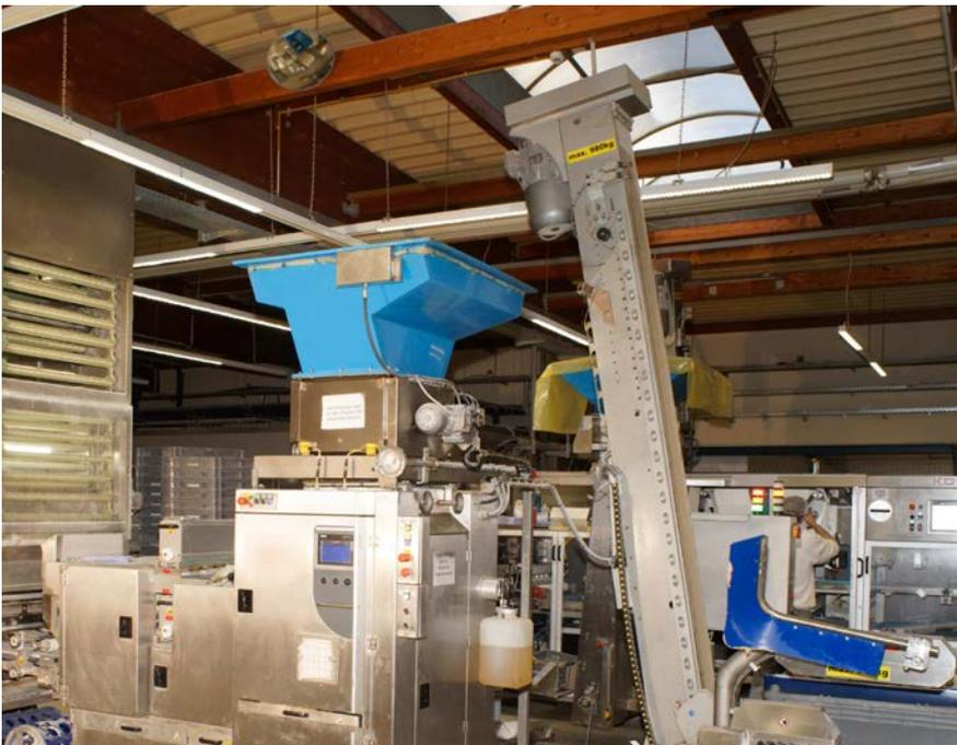
Abb. 24 Teigteil- und Wirkmaschine („Kopfmachine“)
