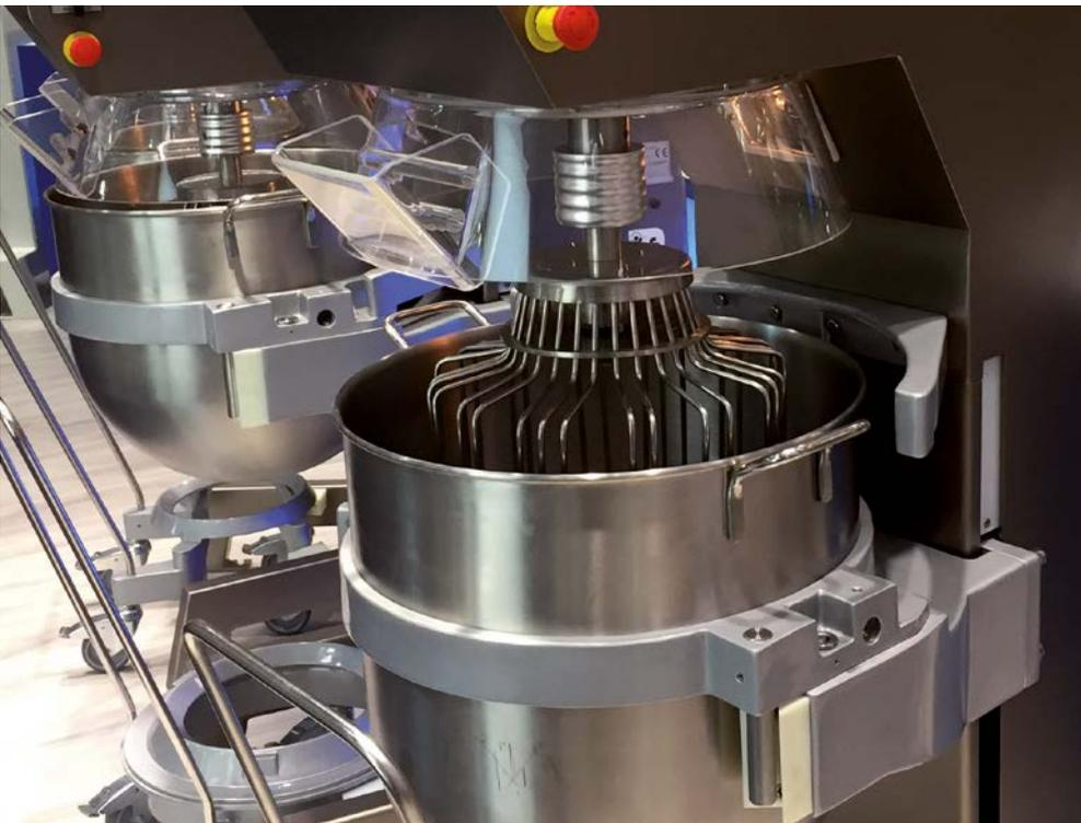
Abb. 14 Planetenrühr- und -knetmaschine mit transparenter Bottichabdeckung
