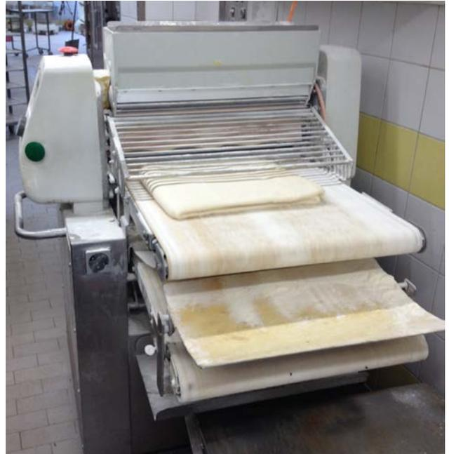
Abb. 21 Kompakt-Langwirkmaschine (Typ 2)
