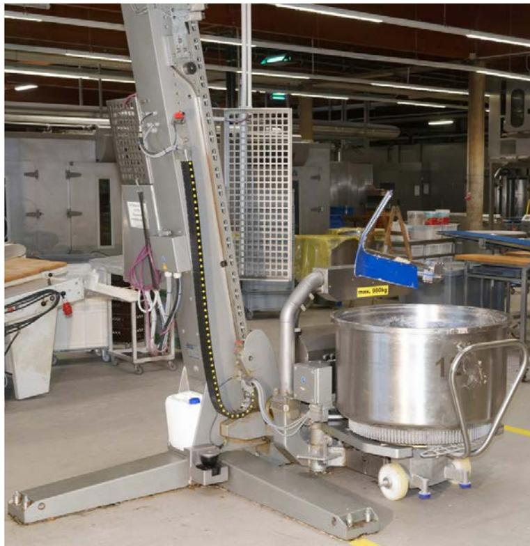
**Abb. 16** Hebekipper mit Teignetbottich
