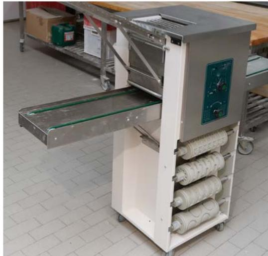
Abb. 34 Gebäckformmaschine
