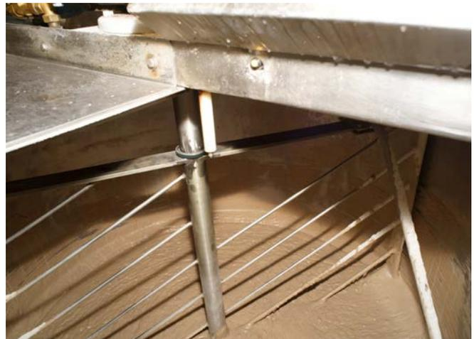
Abb. 11 Rührwerkzeug in einem Sauerteigbehälter
