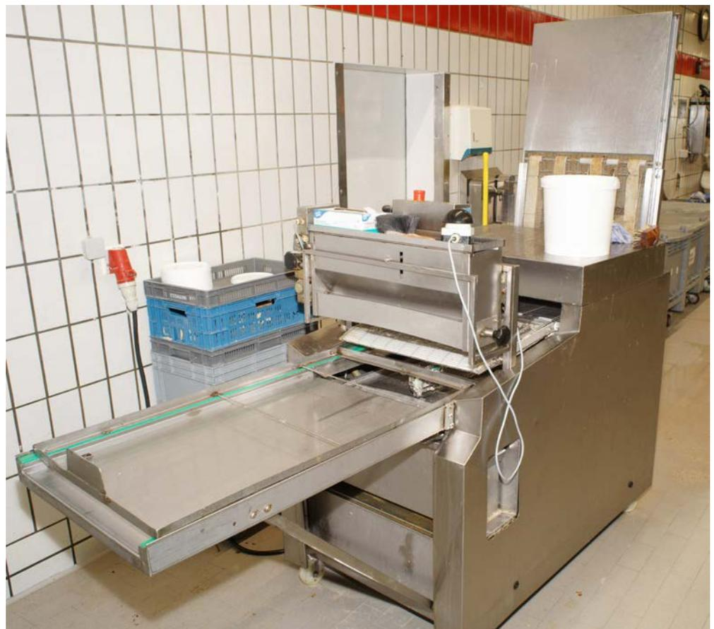
Abb. 31 Automatische Belaugungsmaschine
