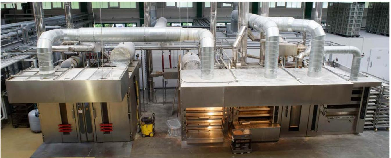
Abb. 43 Backofenanlage mit Abluftführung
