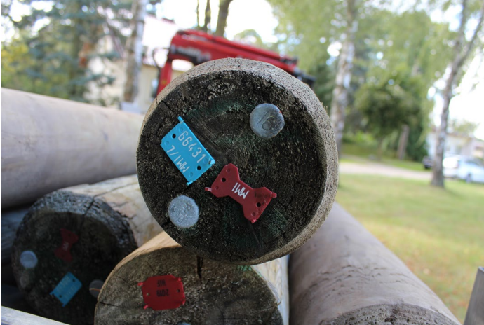
Abb. 7 Beispiel für verschiedene Kennzeichnungen am Mastfuß
