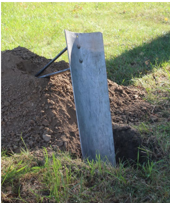
Abb. 14 Mastableiter zum Stellen von Holzmasten in Mastlöchern
