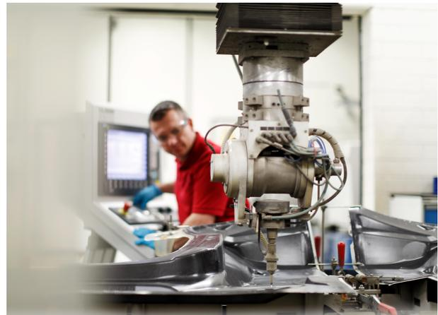
Abbildung 2 – Wasserstrahlschneiden von CFK-Bauteilen
