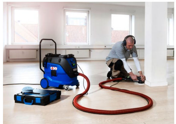
Abb. 10 Absaugung eines handgeführten Elektrowerkzeugs
