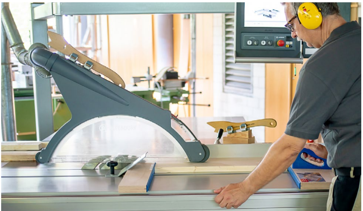
Abb. 8 Absaugung an der Entstehungsstelle
