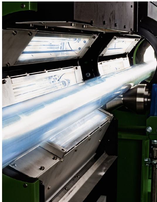
Abb. 3 UV-Härtung von beschichteten Rohren
