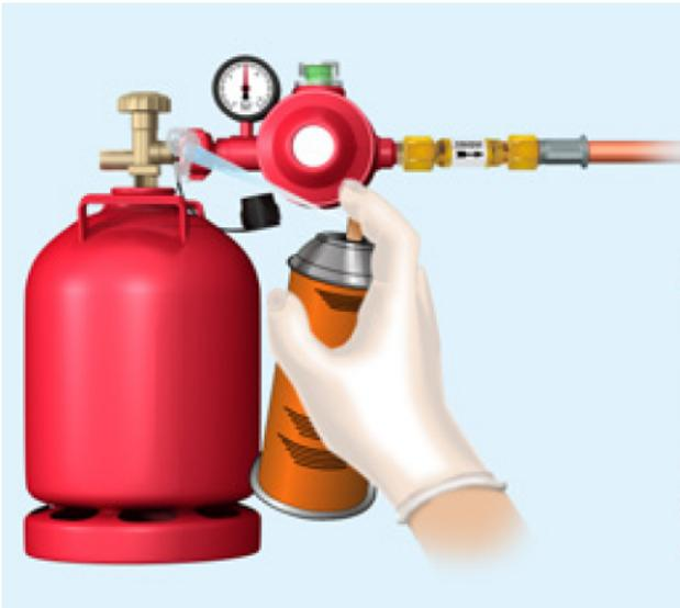
Abbildung 3 – Dichtheitskontrolle mittels Lecksuchspray nach Anschluss der Druckregleinrichtung an die Flüssiggasflasche
