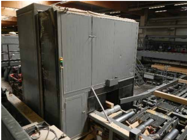
a) Blick auf die Kapsel der Maschine oberhalb der Sägeebene mit Werkstückauslaufbereich
