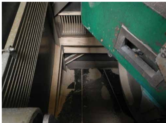
d) Blick vom Zugang in die Einhausung der Blockbandsäge auf die Erfassungsstelle (Gitter) und die Späne-Rutsche.
