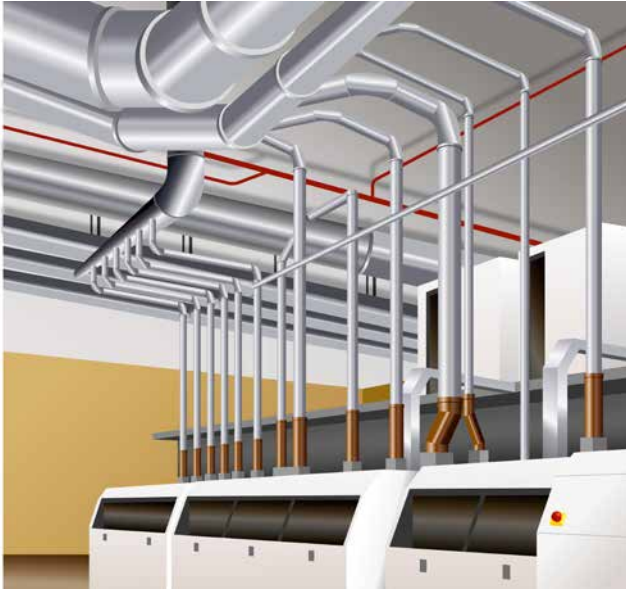
Abb. 98 Absaugung einer Maschine mit mehreren Erfassungsstellen
