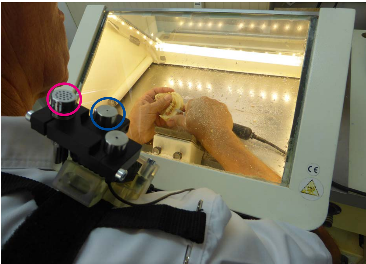
Abbildung G4: Positionierung des Dosimetermikrofons (mittleres Mikrofon, blau) und des Mikrofons des Klasse 1-Schallpegelmessgeräts (linkes Mikrofon, pink). Das rechte Mikrofon ist für diese Auswertung nicht relevant.
