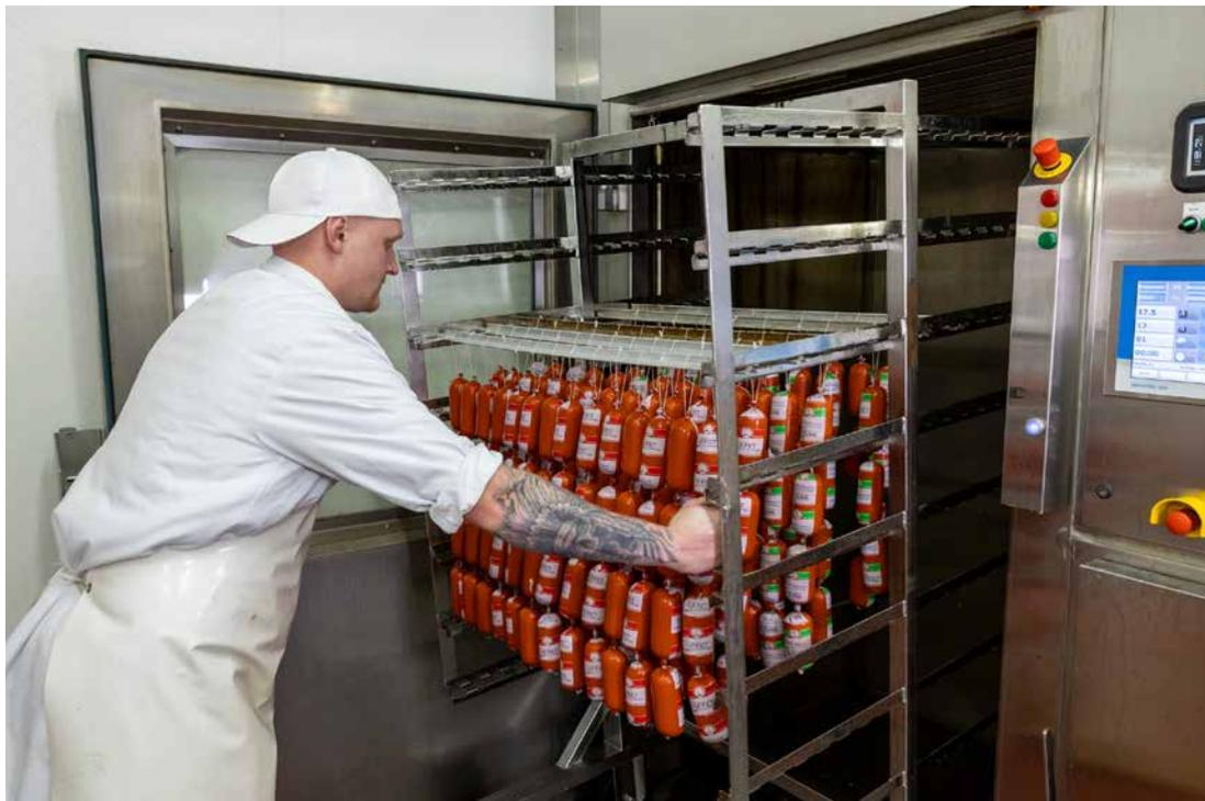
Abb. 76 Beladen einer Räucheranlage mit einem Räucherwagen
