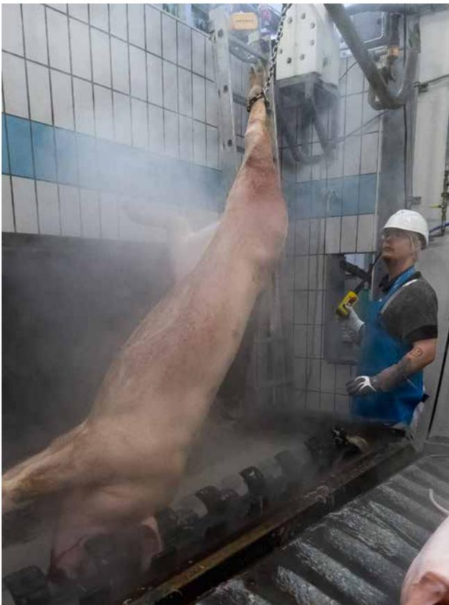
Abb. 55 Arbeiten an der Brüh- und Enthaarungsmaschine
