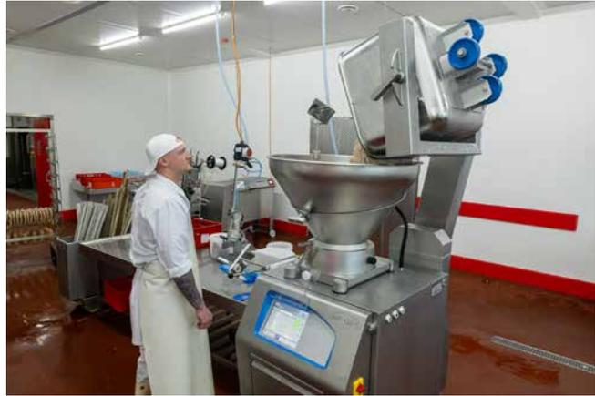
**Abb. 70** Befüllen des Einfülltrichters mittels Hebekipper
