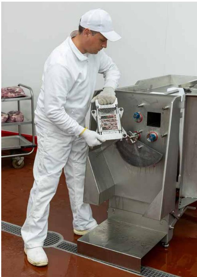
Abb. 74 Wechseln des Gattersatzes am Würfelschneider
