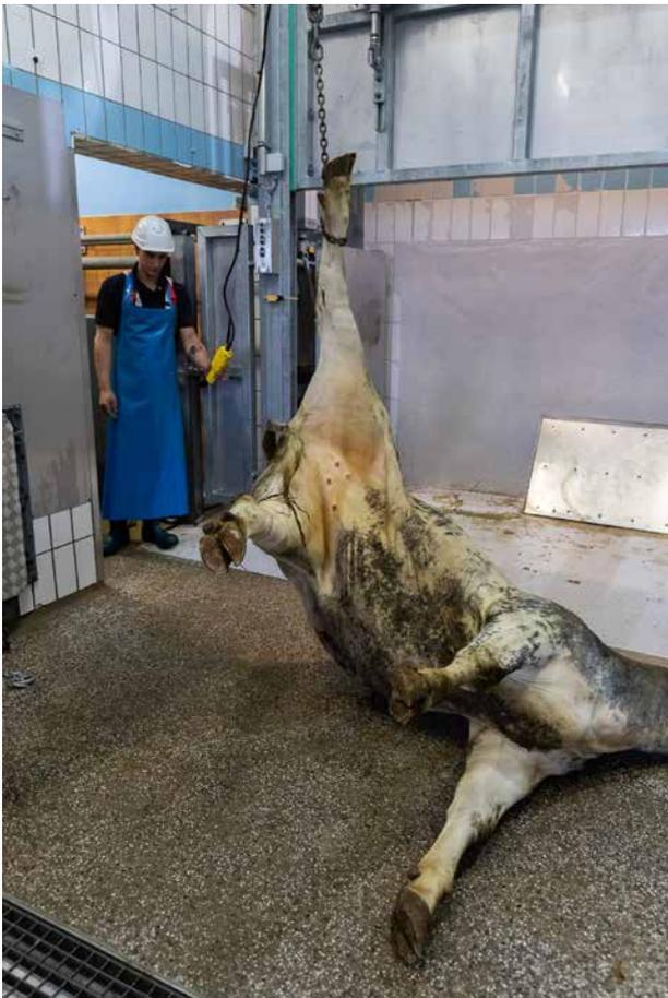
Abb. 52 Bedienung der Winde aus sicherer Position
