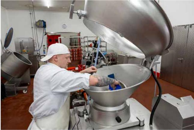
**Abb. 69** Ankratzen von Wurstmasse im geteilten Einfülltrichter
