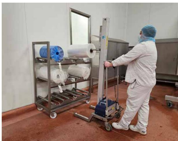
Abb. 12 Benutzung eines Hebelifts für schwere Lasten
