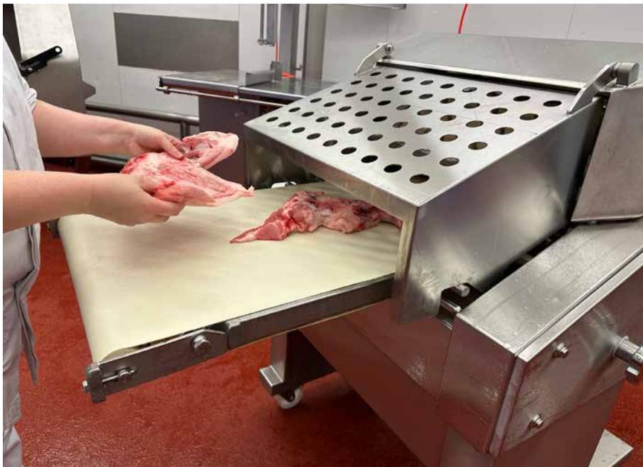
Abb. 62 Arbeiten an einer Entschwartungsmaschine mit automatischer Zuführung
