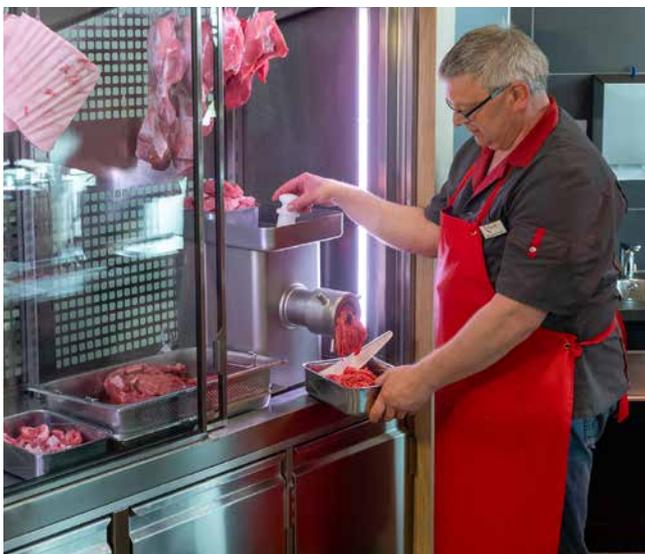
**Abb. 65a** Sichere Benutzung eines Ladenwolfes mit Stopfer
