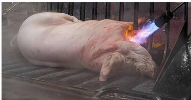
Abb. 57 Arbeiten mit Abflammerät
