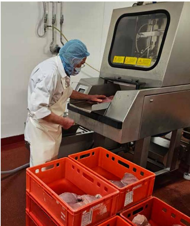
Abb. 73 Arbeiten an einer Pökmaschine
