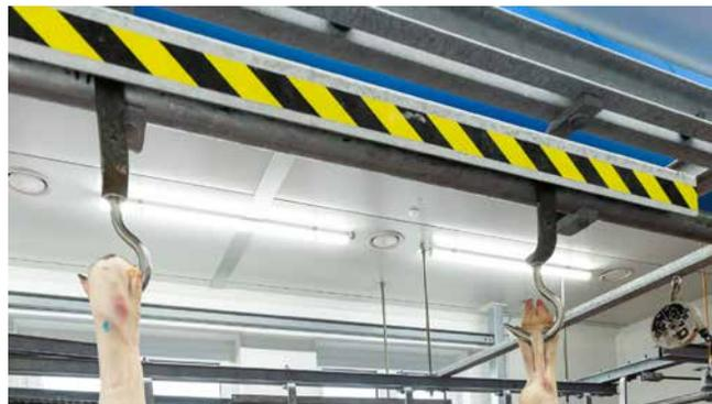
Abb. 24 Abhängesicherung an einer Rohrbahn
