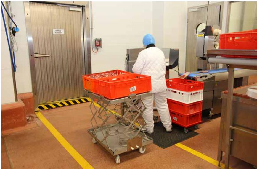
**Abb. 11** Einsatz eines ergonomisch bedienbaren Scherenhubwagens
