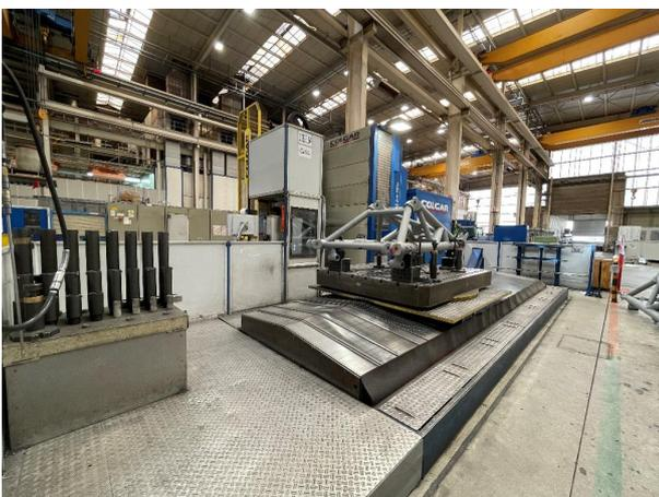
Abbildung 4 – Großzerspanungsmaschine mit Zugangsabsicherung, bestehend aus feststehend trennenden und nicht trennenden Schutzeinrichtungen (Lichtschranke rechts im Bild).
