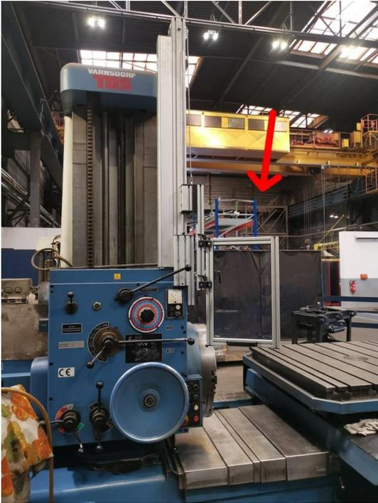
Abbildung 2 – Handgesteuertes Universalbohrwerk mit vertikal einstellbarer Schutzeinrichtung
