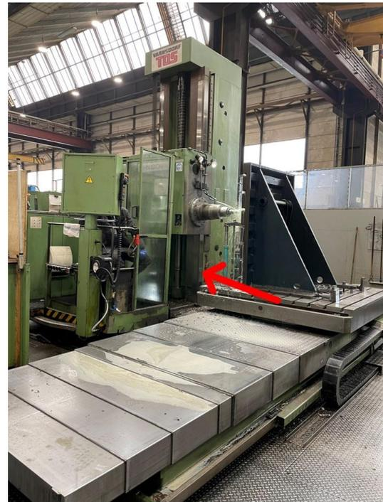
Abbildung 3 – Numerisch gesteuertes Universalbohrwerk mit verriegelten, beweglichen trennenden Schutzeinrichtungen am Bedienstand
