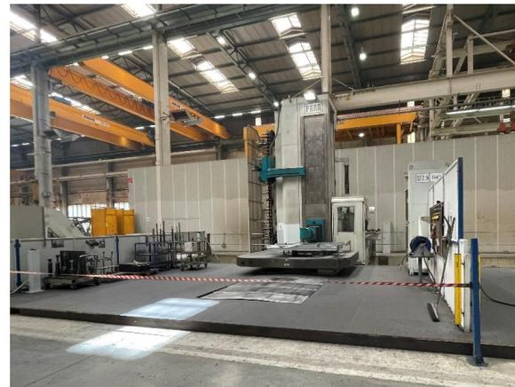
Abbildung 1 – Großzerspanungsmaschinen mit allseitiger Zugangsabsicherung und gesichertem Bedienstand. Im vorderen Bereich gesichert durch Lichtschranken, das Absperrband ist nur ein Hinweis, um ein zufälliges Betreten des Maschinenraumes zu verhindern.
