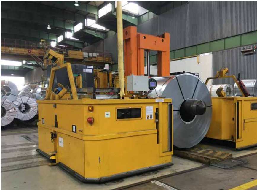
Abb. 36 Sog. fahrerloses Transportsystem mit Coilaufnahme
