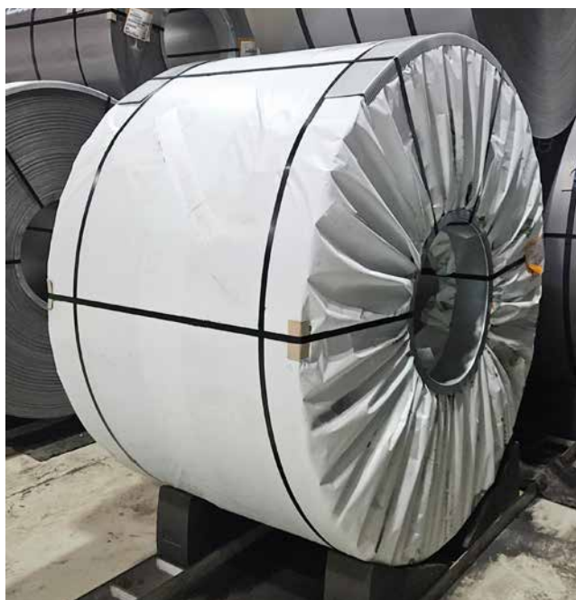
Abb. 25 Umreiftes und verpacktes Coil mit Kantenschoner
