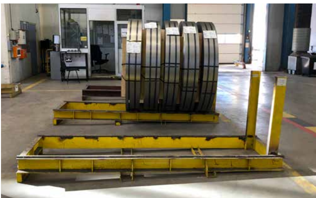
Abb. 11 Im Coilgestell gelagerte Coils
