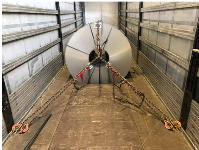
Abb. 10 In Coilmulde im LKW befestigtes Coil, festgezurt mit Ketten, angebrachte Kantenschoner
