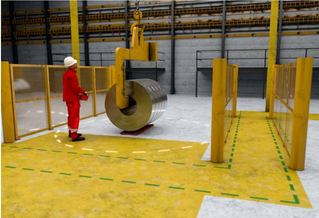
Abb. 30 Gekennzeichnete Verkehrswege, Kranbereich markiert
