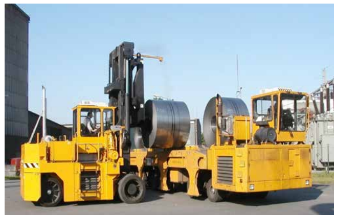
Abb. 41 Coiltransporter – Beladevorgang mit Dornstapler
