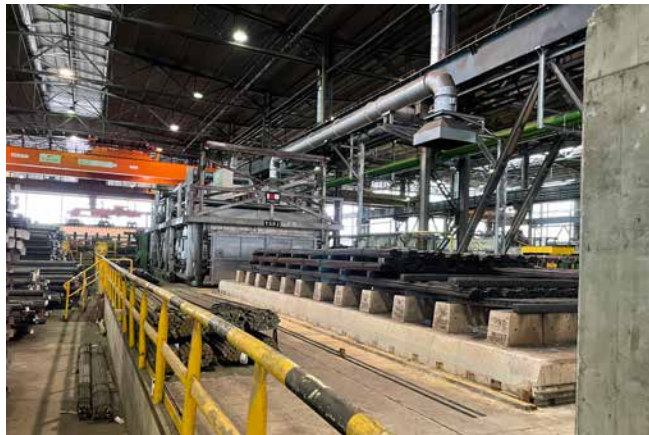
Abb. 28 Multi-Stack oder Mehrstapel-Haubenglühofen
