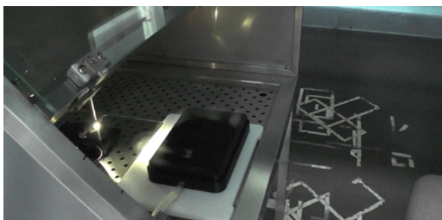
Abbildung B.13: Nebeldosiersystem auf dem kleinen Schneidbrett in Pathologietisch mit geöffneter Haube
