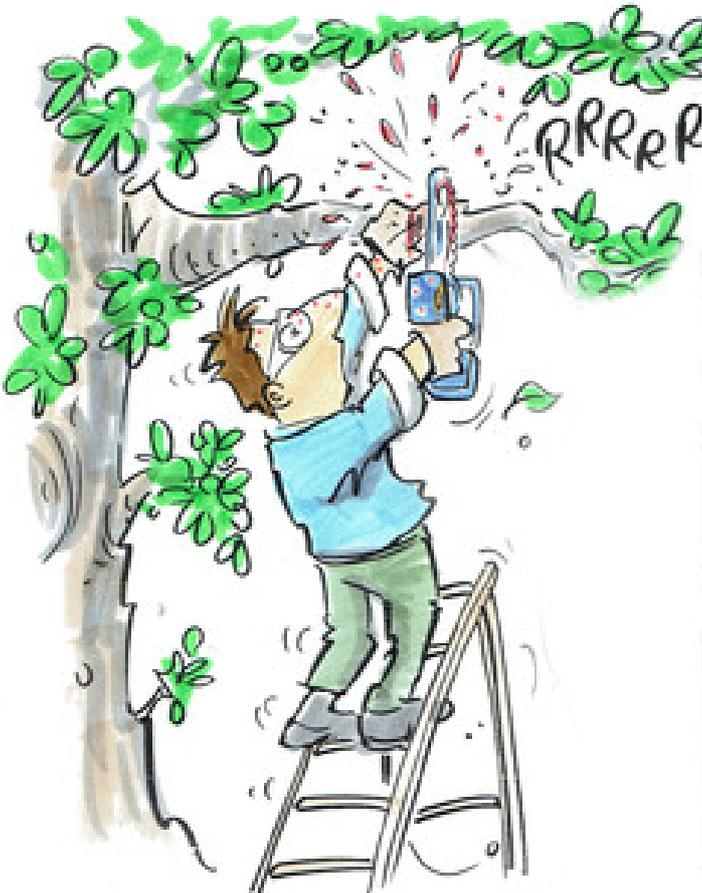
Als Gehölzschnider bezeichnen die Hersteller kompakte akkubetriebene Elektrogeräte, welche mit einem Pistolenhandgriff und einer umlaufenden Sägekette ausgestattet sind. Durch den Pistolenhandgriff ist eine einhändige Bedienung möglich und im praktischen Einsatz zu erwarten, obwohl ein zweiter Handgriff vorhanden ist.
