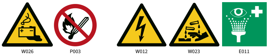
Abb. 11 Mögliche Kennzeichnungen für Batterieräume, Ladeplätze oder Laderäume
