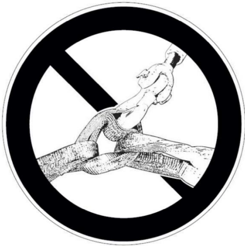
Abbildung 5 – Falsch in Zwischenlage eingehängter Haken
