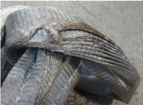
Abbildung 10 – Beispiel für Abriebschäden
