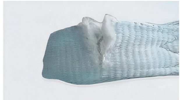
Abbildung 12 – Einschnitt im Kettenglied
