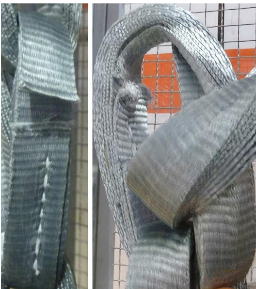
Abbildung 11 – Durchtrennte Lage auf der Außenseite (links) bzw. der Innenseite (rechts) eines Kettengliedes
