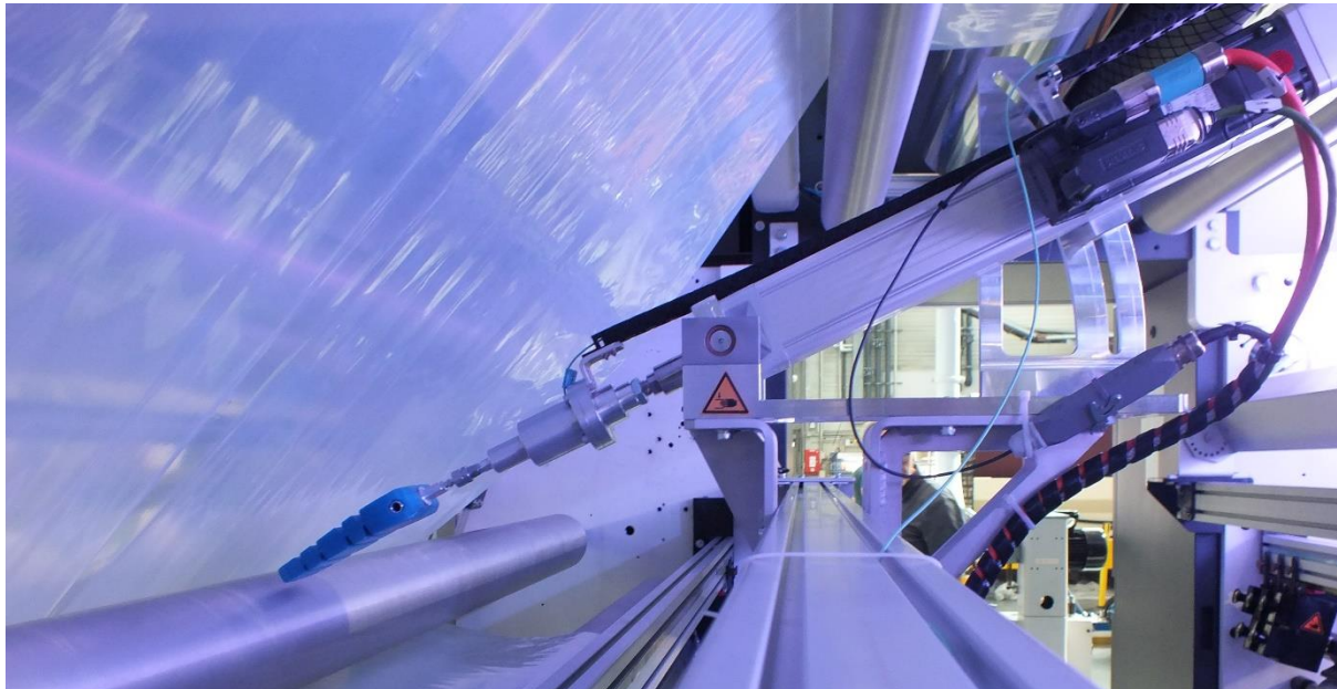
Abbildung 15: Anbringung der Messeinrichtung an der Folienauflaufstelle.
