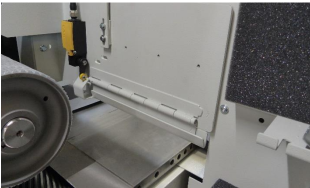
Abbildung 5 – Mögliche Sicherungsmaßnahme einer Schalleiste – Aufnahme von innerhalb der Haube
