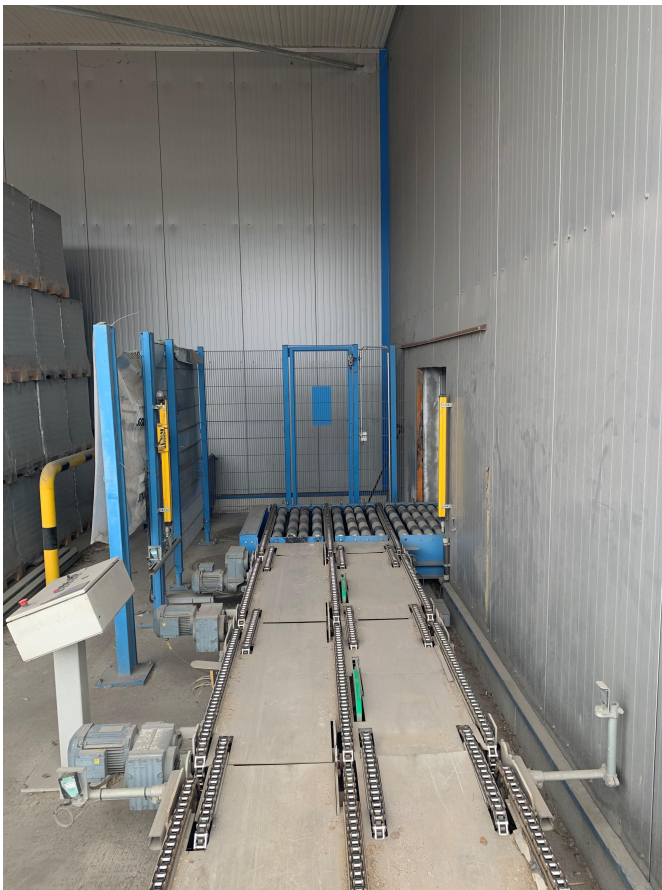
Abbildung 7 – Muting-Sicherheitslichtschranke an der Ausschleusung
