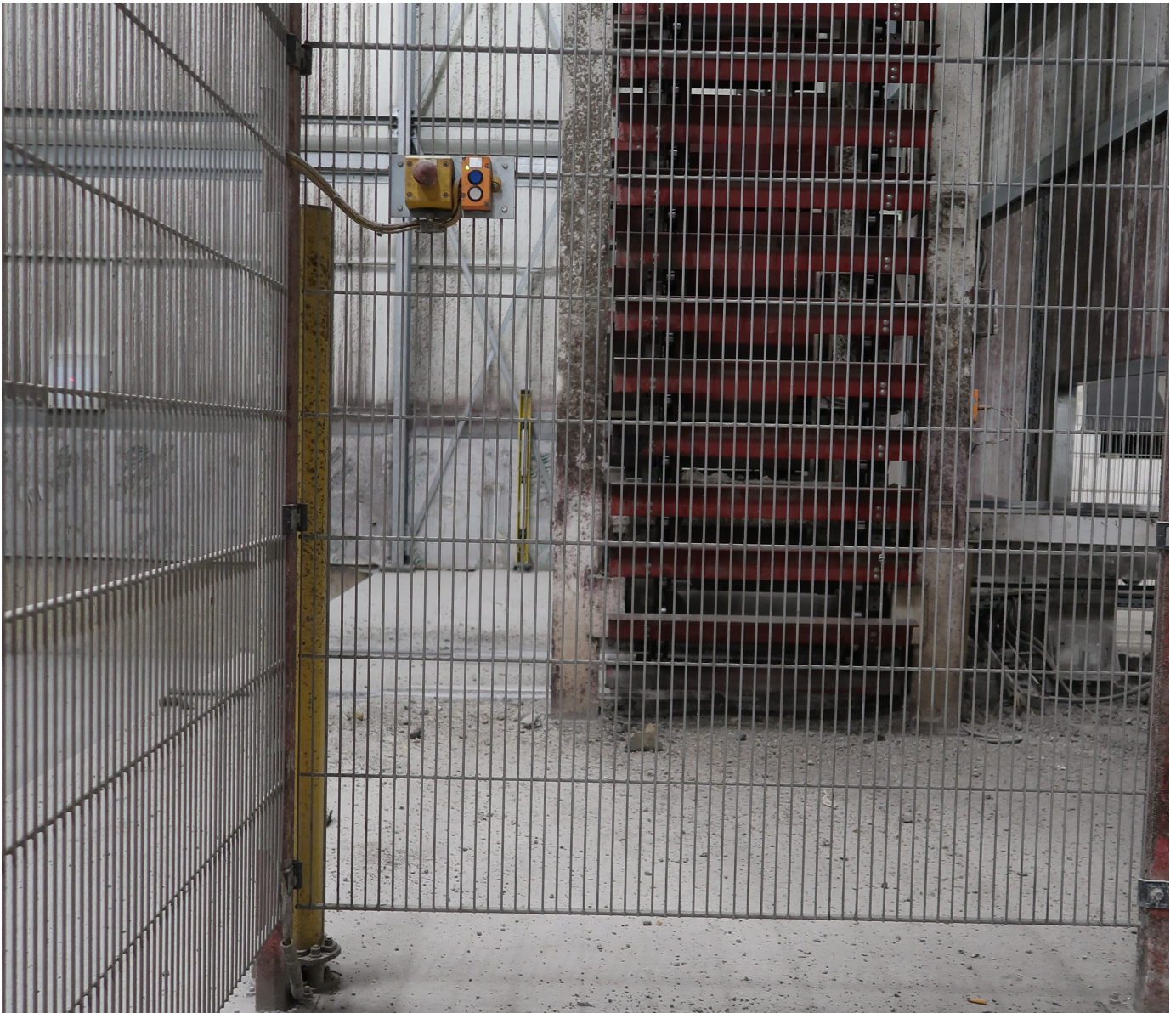
Abbildung 4 – Lichtvorhang im Schiebebühnenkanal
