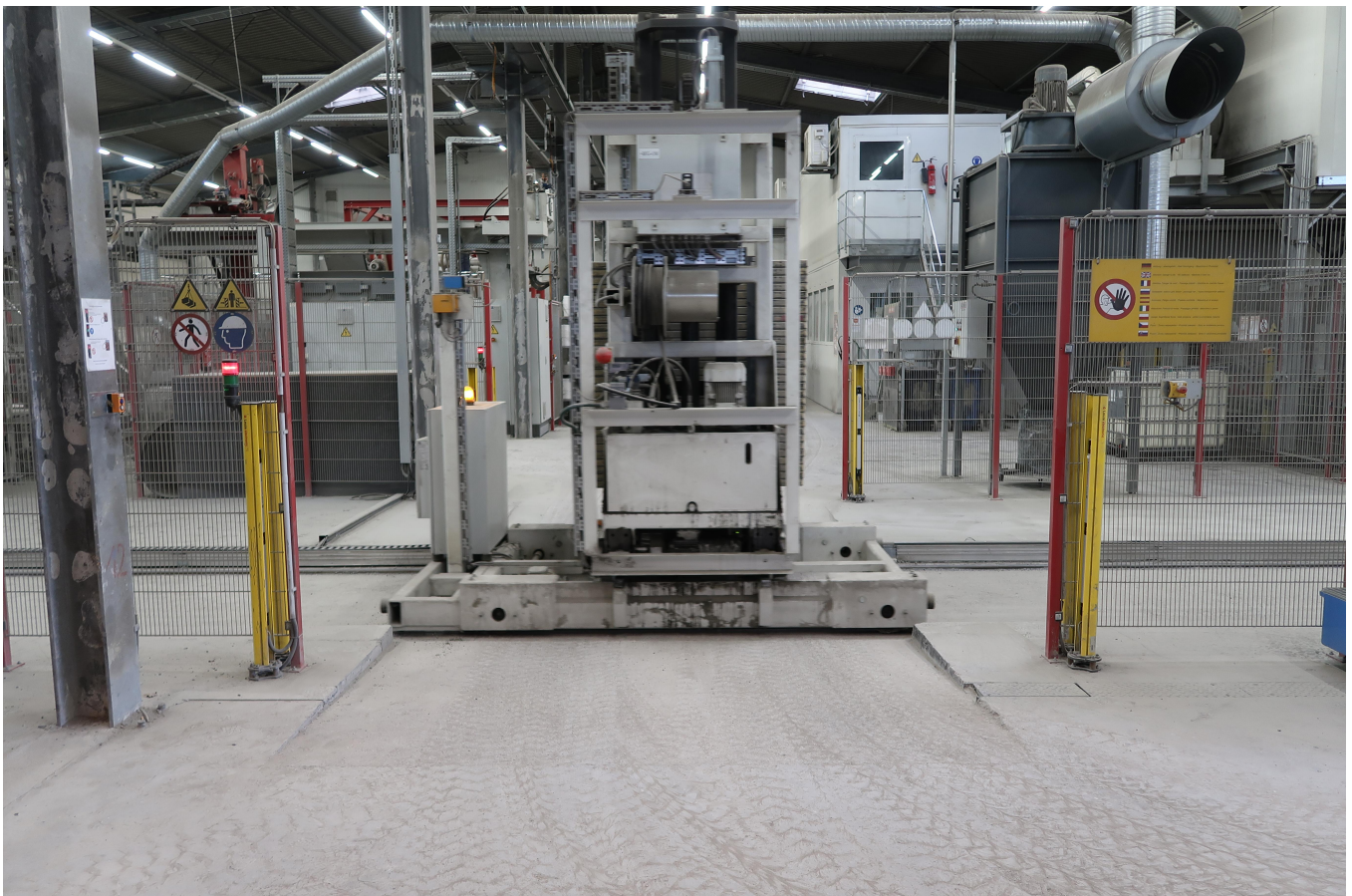
Abbildung 9 – Brettstapelrückführung mit Transportwagen im durch Lichtschranken abgesicherten Bereich
