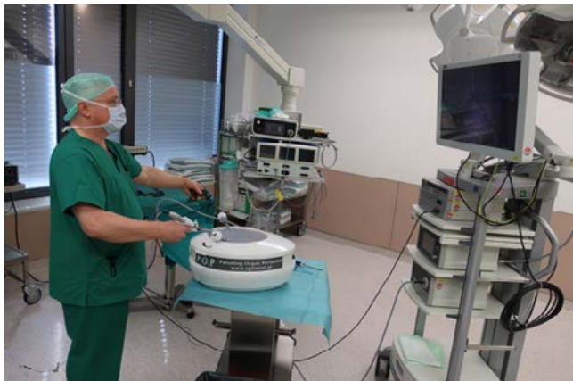
Messung der Vibrationsbelastung an Ultraschallskalpellen.
