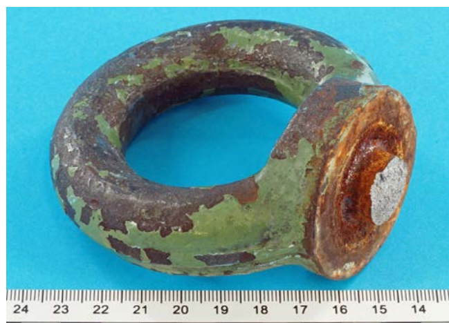
Unfalluntersuchung an einer gebrochenen Ringschraube.
