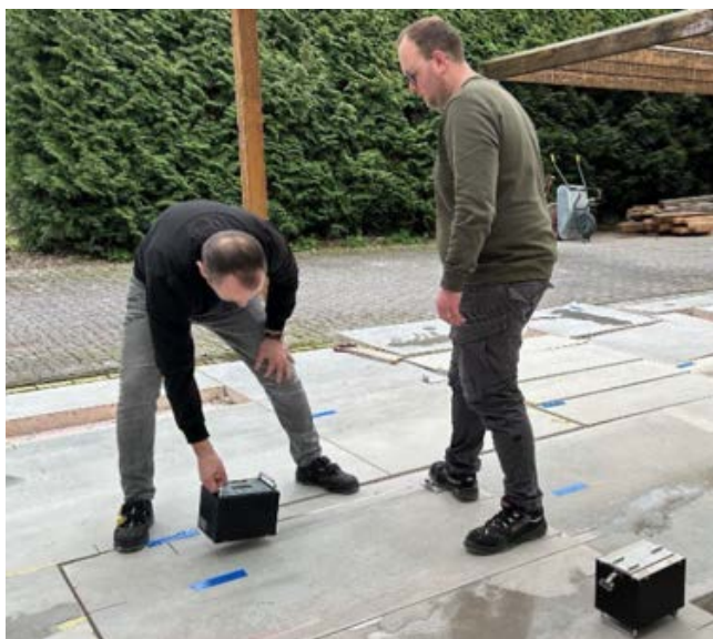
Messung des Gleitreibungskoeffizienten \mu mit dem Gleitmessgerät GMG 200.
