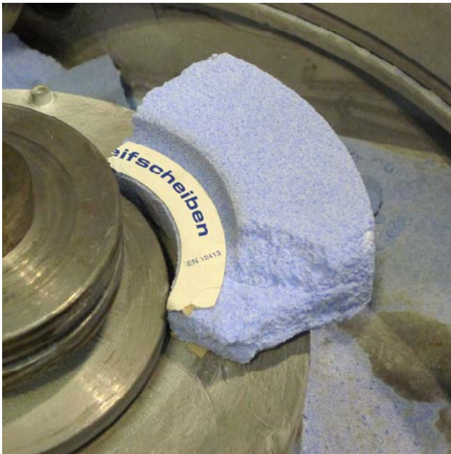
Der Spitzenschalldruckpegel einer berstenden Schleifscheibe wurde vom IFA durch eine Nachstellung im Labor ermittelt.
