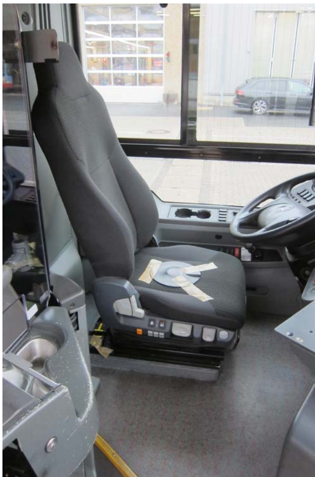
Messung der Vibrationsbelastung beim Einsatz eines Busses im Linienverkehr.
