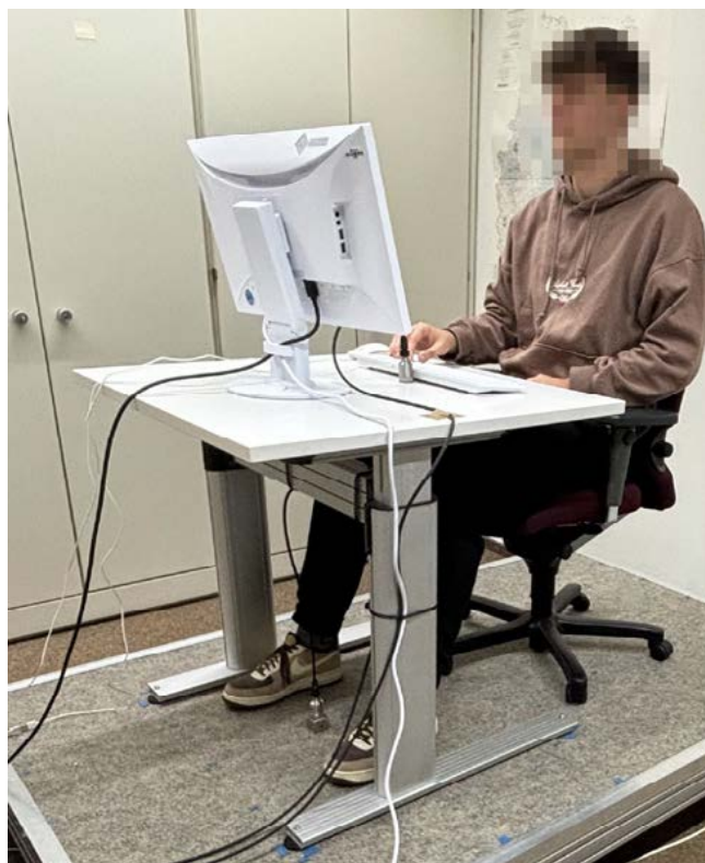
Prüfstand zur Bestimmung der Konzentrations- und Leistungsfähigkeit unter einer Schwingungseinwirkung.
