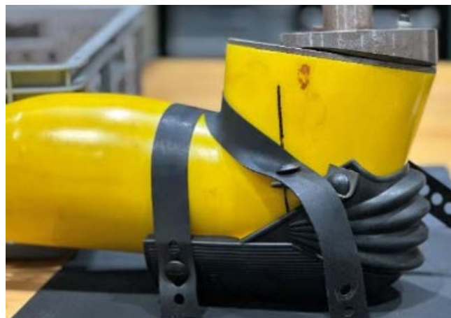
Prüfaufbau Dauerbelastung Knieschutz mit dem Prüfknies.
