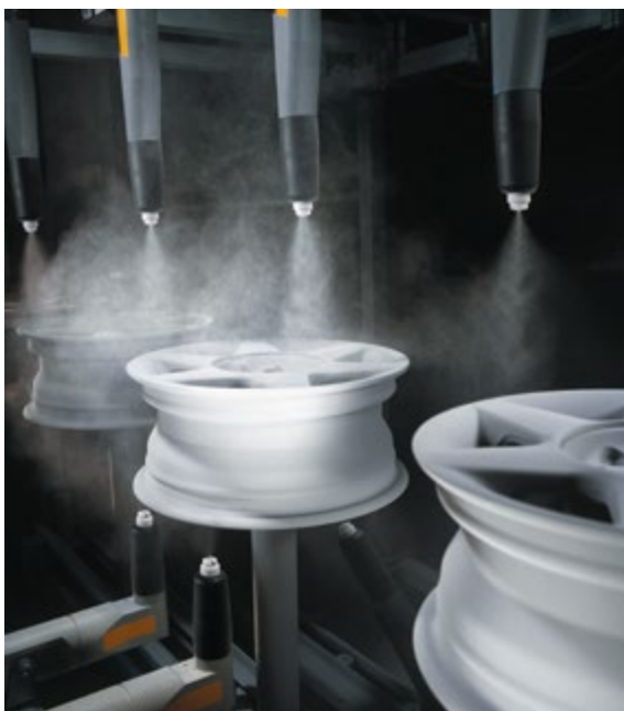
Abb. A10-9 Sprühsystem zur Pulverbeschichtung von Pkw-Aluminiumräder für Klarlack
