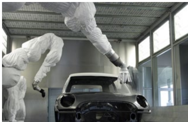
Abb. A10-5 Robotergeführtes Hochrotations-Sprühsystem zur Beschichtung von Pkw-Karosserien, rechts: Außenaufladung, links: Direktaufladung
