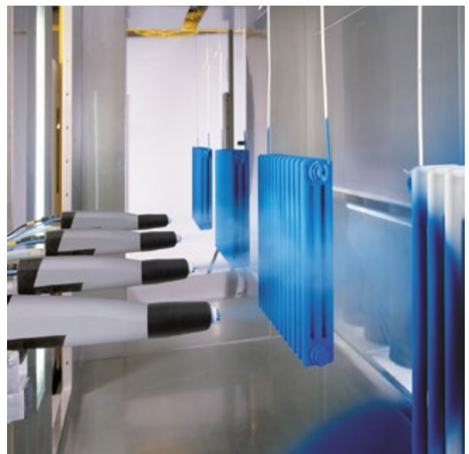
Abb. A10-10 Sprühsystem zur Pulverbeschichtung von Heizkörpern mit Vertikal-Bewegungsautomat
