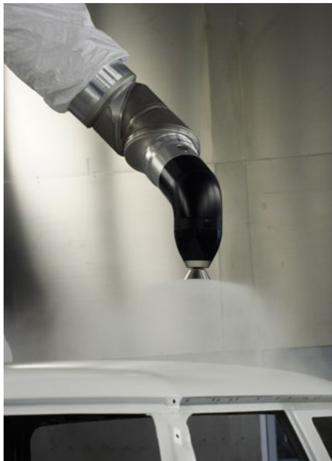
Abb. A10-6 Hochrotations-Sprühsystem zur Beschichtung von Pkw-Karosserien mit Direktaufladung
