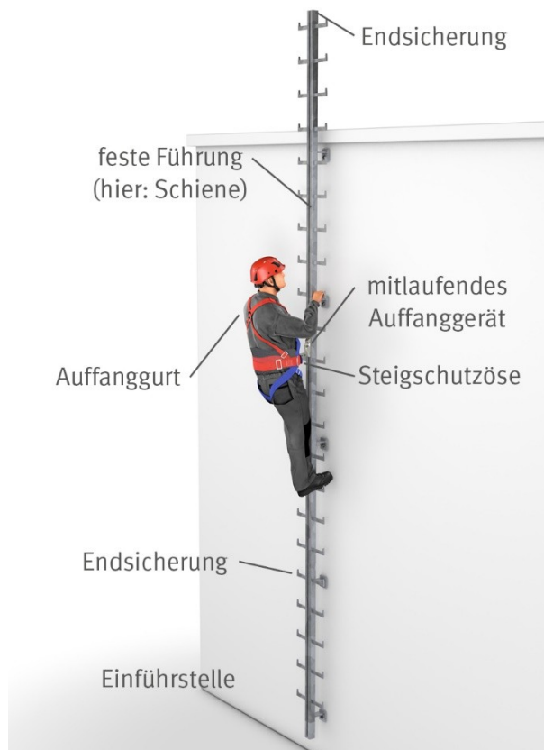
Abbildung 1 – Prinzipskizze des Auffangsystems mit einem mitlaufenden Auffanggerät einschließlich fester Führung
