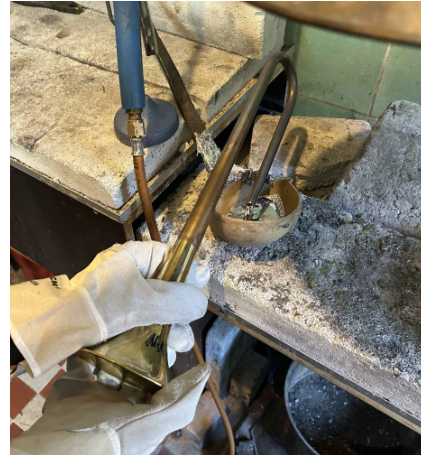
Abbildung 4: Manuelles Ausschmelzen mittels Gasbrenner
