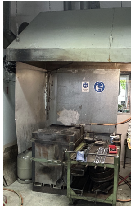
Abbildung 3: Schmelzen von Blei unter Absaugung im Metallblasinstrumentenbau
