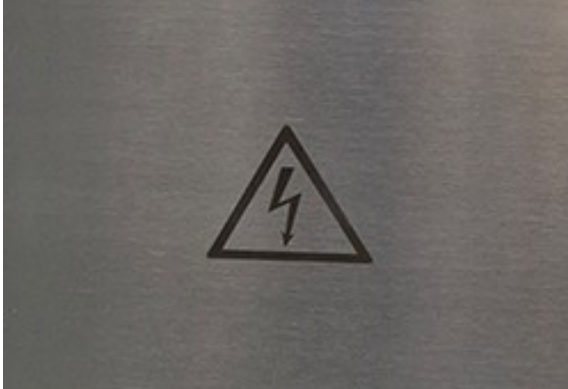
Abbildungen 3a und 3b – Gelaserte Sicherheitskennzeichen auf verschiedenen Maschinenoberflächen
