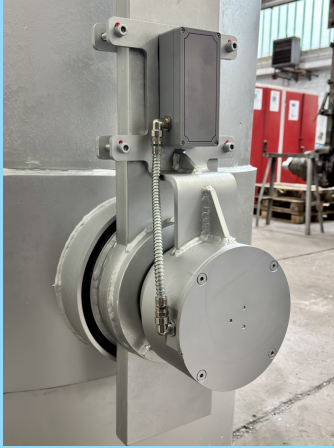
Abbildung 2 – Beispiel eines Datenerfassungsgerätes an einer Pfanne
