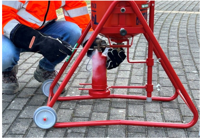
Abbildung 7: Schließen der Ventile nach Abschluss des Füllvorgangs
