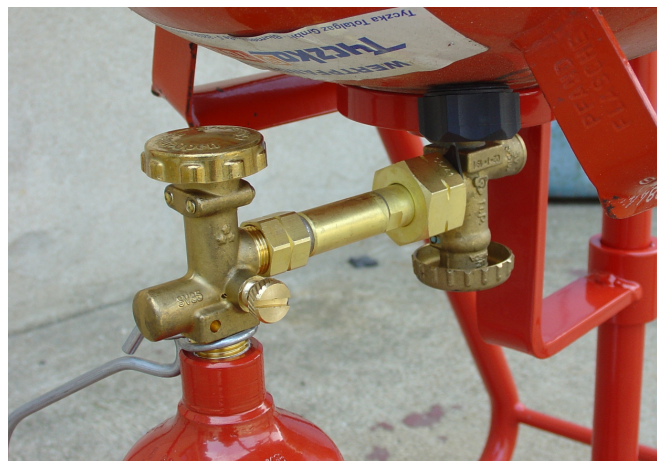
Abbildung 4: Verbindung beider Flaschen mit Füllstutzen
