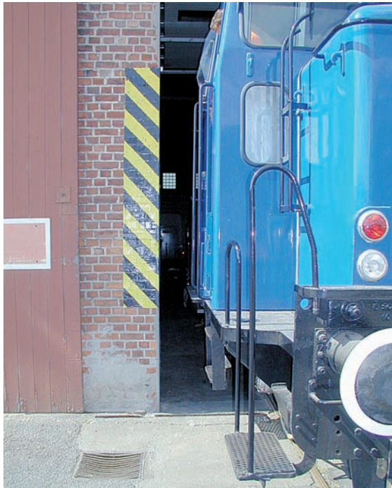
Abbildung 12: Durch die schwarzgelbe Markierung wird darauf aufmerksam gemacht, dass der Sicherheitsabstand unterschritten ist.
