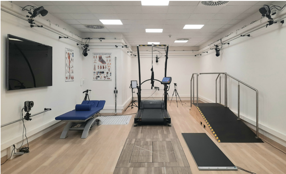
Abbildung 1: Motoriklabor der BG Klinik Ludwigshafen, ausgestattet mit u. a. Infrarotkameras und Kraft- messplatten zur Quantifizierung von Bewegung und Belastung.
