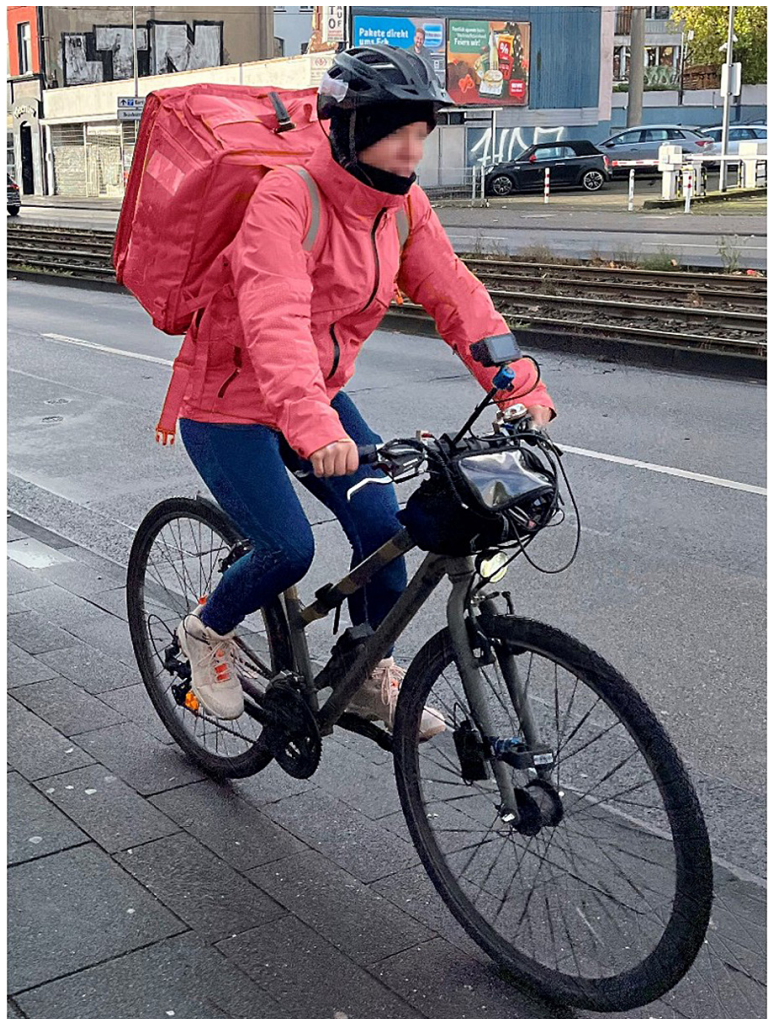
Abbildung 1: Untersuchung der mechanischen und physikalischen Expositionen; 1: Garmin Rally RS200 Powermeter, 2: Beschleunigungsaufnehmer auf dem Sattel und Sattelstütze, 3: Beschleunigungsaufnehmer auf dem Lenkergriff und Lenkerstange
