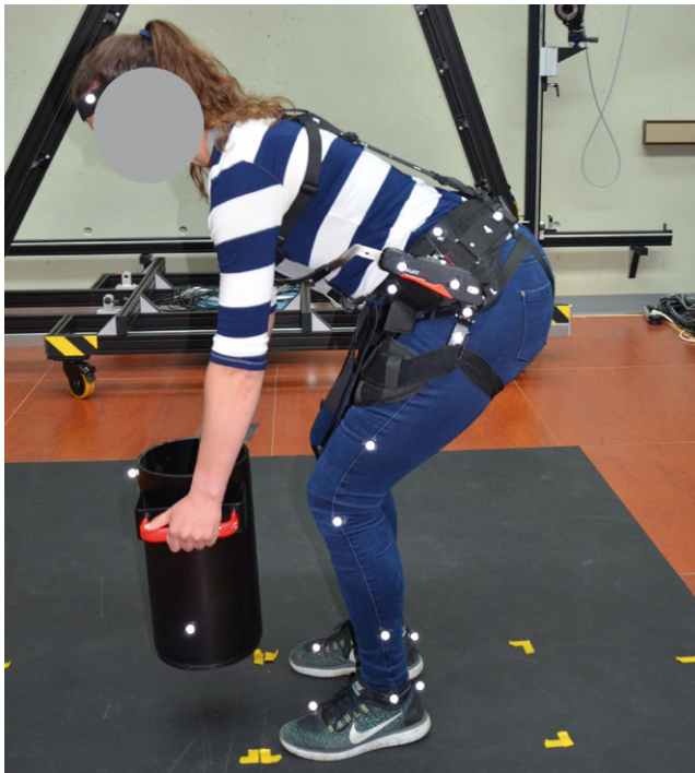
Abbildung 2: Versuchsaufbau zum Testen von Exoskeletten im Labor. Bild: IFA
