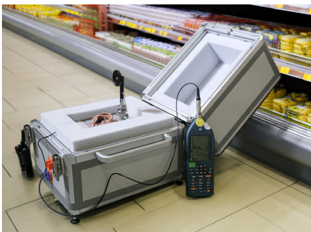
Abbildung 1: VINCENT – Messapparatur zur Ermittlung des ohrnahen Schalldruckpegels beim Tragen von Headsets, Foto mit Schallpegelanalysator, Funkgerät und im künstlichen Ohr eingesetztem Headset. Foto: IFA, Hintergrund KI-generiert
